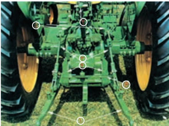
شکل ۳-۳- اجزای اتصال سه نقطه (در تراکتور JD ۳۱۴۰)
