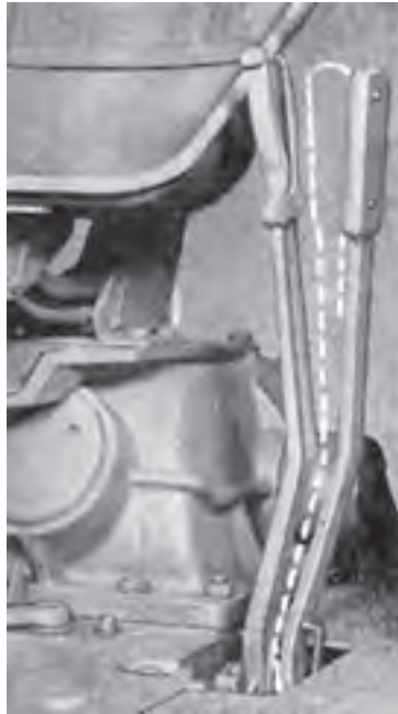
شکل ۷-۲- اهرم دیفرانسیل جلو (در تراکتور M ۶۵۰ U)
