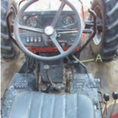
شکل ۲-۱- جفت کن پدال ترمز در تراکتور MF۳۹۹
