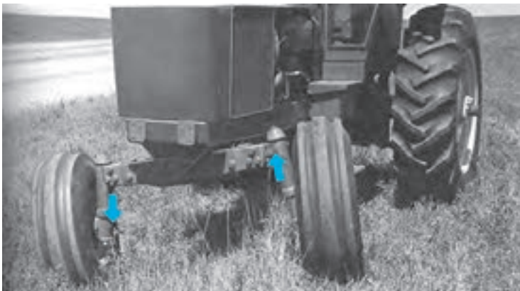
شکل ۳-۲- حالت الاکلنگی محور جلو در تراکتورهای چهارچرخ
