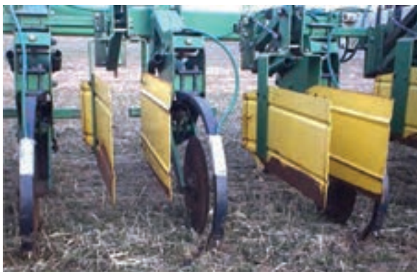
شکل ۳-۵- سپرهای محافظ در پنجه مشخص هستند.
