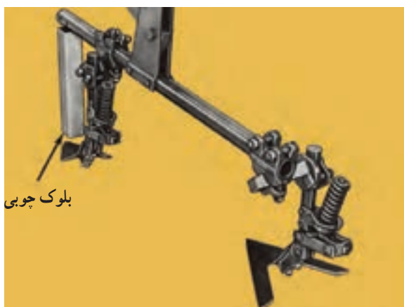
شکل ۱۲-۳- استفاده از قطعه چوب برای تراز پنجه
