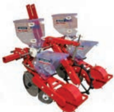
شکل ۹-۴- بذرکار دو ردیفه تراکتوری مجهز به کودکار
