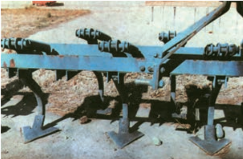
شکل ۵-۶- کولتیواتور فندار با تیغه پنجه‌غازی
