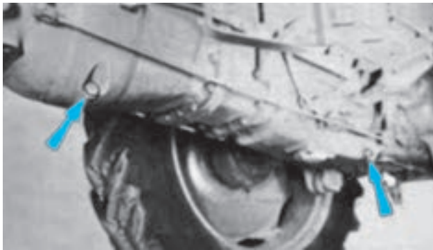
شکل ۳-۶- تخلیه های روغن هیدرولیک تراکتور MF ۲۸۵
