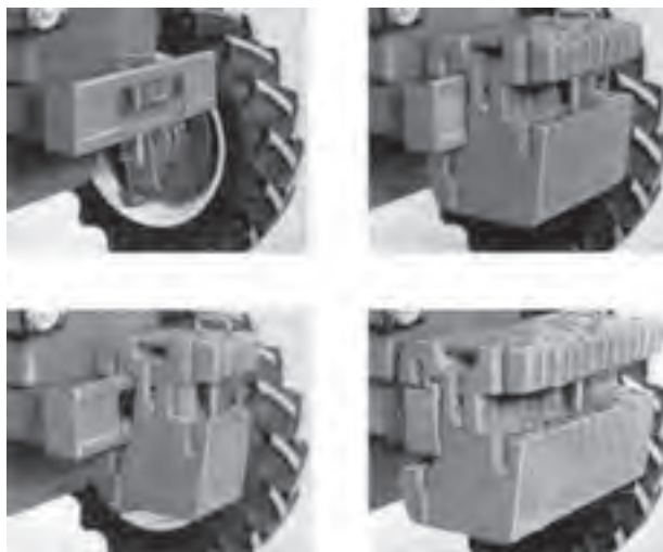
شکل ۲۲-۸- وزنه‌های جلوی تراکتور JD ۳۱۴۰
