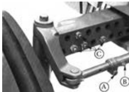
شکل ۱۶-۸- محور جلوی تراکتور JD ۳۱۴۰
