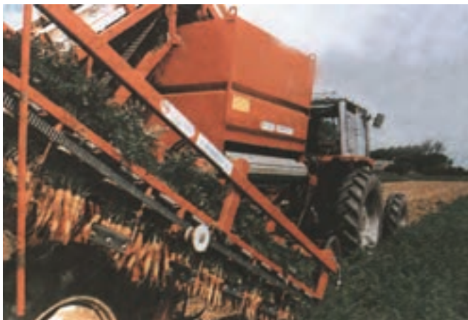
شکل ۸-۷ - برداشت مکانیزه هویج
