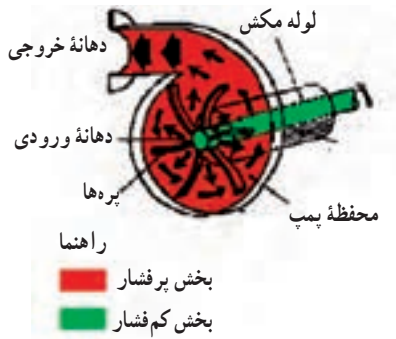
شکل ۱-۲- مسیر حرکت سیال در پمپ گریز از مرکز
