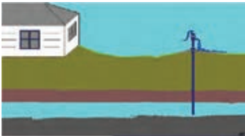
شکل ۸-۱- پمپ آب دستی
