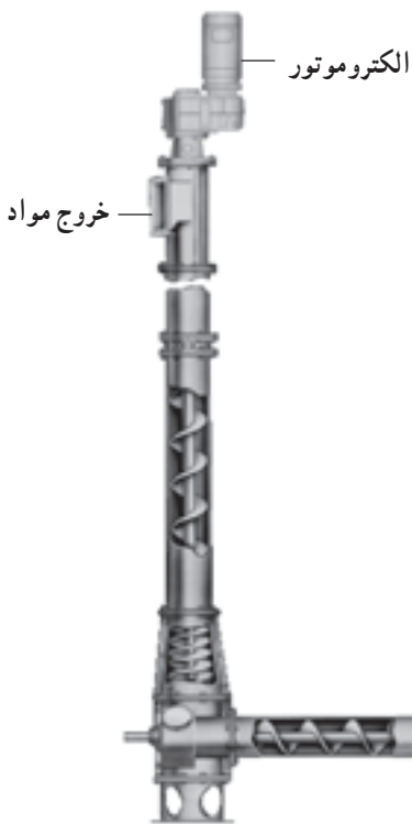
شکل ۲۰-۱- نقاله ماریچی مخصوص مسیرهای شیبدار
