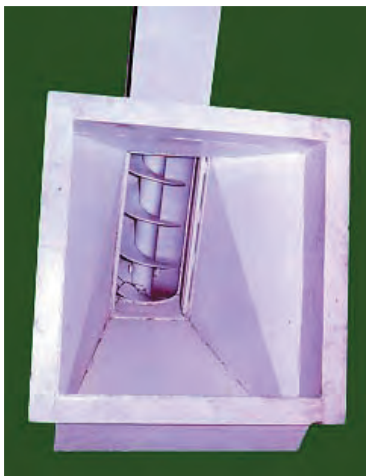
شکل ۱۵-۱- دریچه ورودی نقاله
