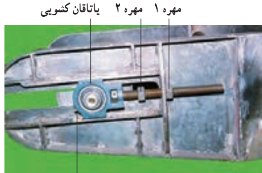
شکل ۱۱-۱- تنظیم کننده کشیدگی تسمه نقاله
