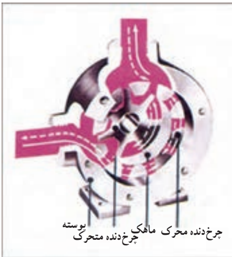
شکل ۳-۵- طرز جریان سیال در پمپ دنده داخلی
