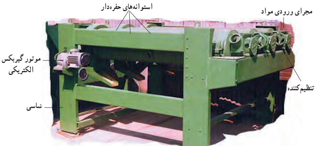
شکل ۲-۸- دستگاه بوجاری استوانه حفره‌دار
