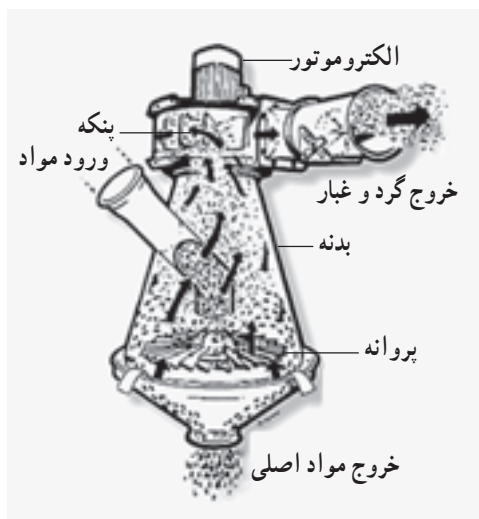
شکل ۲-۷- طرح کلی تمیزکننده گردبادی
