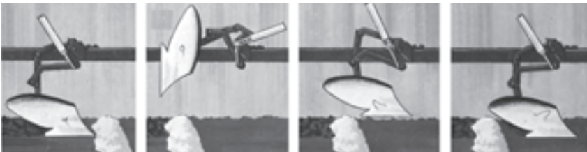
ب - عبور از مانع بزرگ با چرخش خیش به سمت بالا
