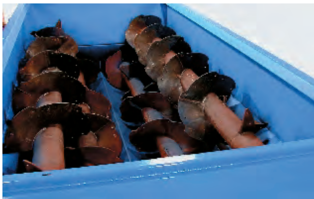
شکل ۴-۵- ماریچ‌های مخلوط‌کن در مخزن مواد
