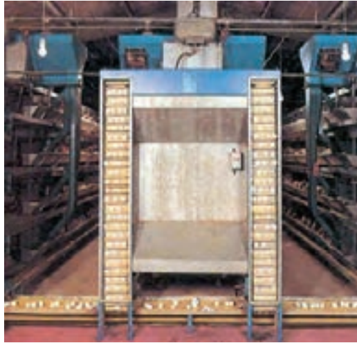
شکل ۳-۷۸- جمع آوری تخم مرغ‌ها در انتهای قفس‌ها
