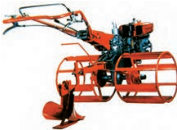
شکل ۴-۵- تراکتور دو چرخ مجهز به شیارکش و چرخهای مخصوص باتالاق
