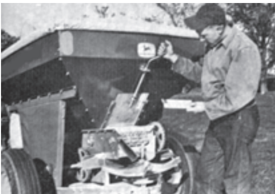
شکل ۷-۵ — اهرم کنترل دریچه
