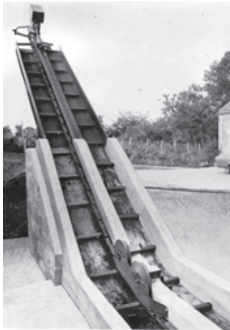
شکل ۳۰-۴- سطح شیبدار در انتهای مسیر نقاله
