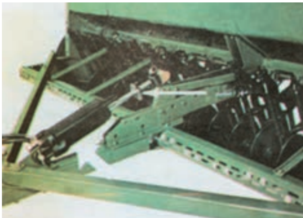
شکل ۱۵-۶- تنظیم عمق کاشت توسط جک هیدرولیک
