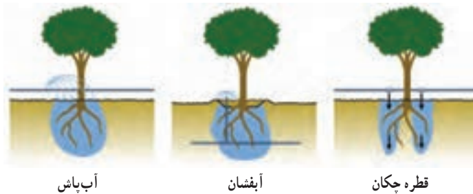
شکل ۷-۹۴- حالت نفوذ آب در انواع روش‌های آبیاری
