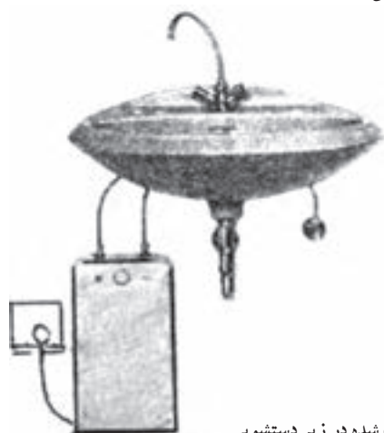
شکل ۲-۵- آبگرمکن نصب شده در زیر دستشویی
