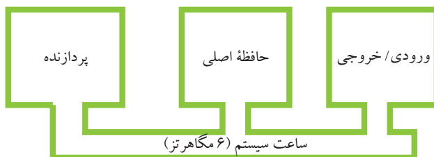
شکل ۲۰-۲ گذرگاه واحد در رایانه‌های اولیه، نسل XT، ساختار اصلی یک
