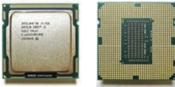
شکل ۳-۴۰ جلو و پشت پردازنده Intel Core i5-750
