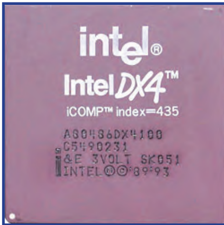
شکل ۲۲-۳ پردازنده ۴۸۶ DX ۴/۱۰۰ با سرعت ۱۰۰ مگاهرتز و سوکت شماره ۳
