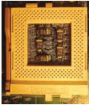
شکل ۲۸-۳ پردازنده پنتیوم ۷۵ و سوکت شماره ۵
