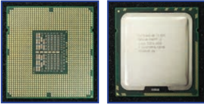
شکل ۳۷-۳ جلو و پشت پردازنده Intel core i7-975
