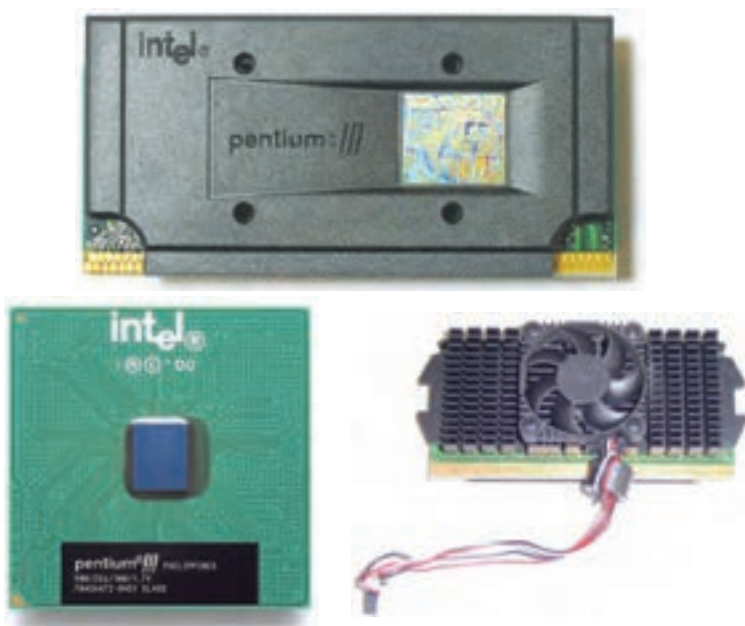
شکل ۳-۳۳ پردازنده پنتیوم III با ساختار شکاف ۱ (بالا)، پروانه خنک کننده آن و پنتیوم III با شکل کلاسیک (پایین)
