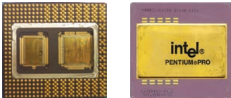
شکل ۳۰-۳ جلو و پشت پردازنده پنتیوم پرو با فرکانس ۲۰۰ مگاهرتز
