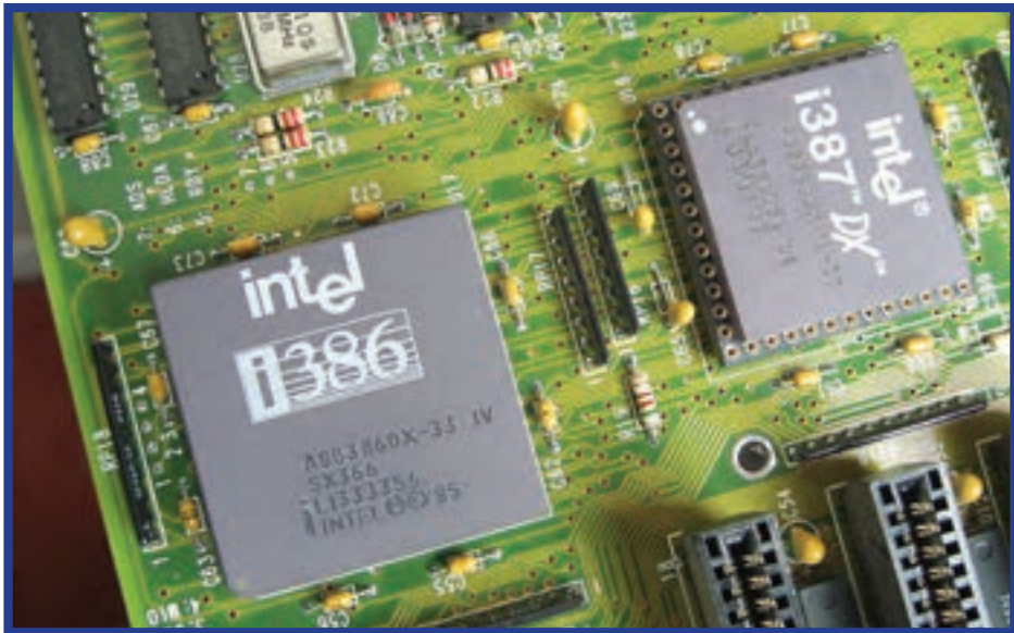
شکل ۲۱-۳ پردازنده ۸۰۳۸۶ DX و کمک پردازنده ۸۰۳۸۷ محصول شرکت اینتل
