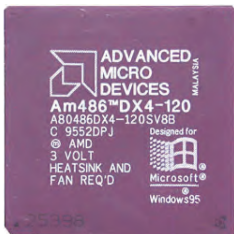
شکل ۲۵-۳ پردازنده AM486 DX4 از شرکت AMD مشابه خانواده DX 486 Intel با سرعت ۱۲۰ مگاهرتز
