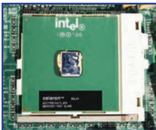
شکل ۳۲-۳ پردازنده سلرون و سوکت ۳۷۰ PGA
