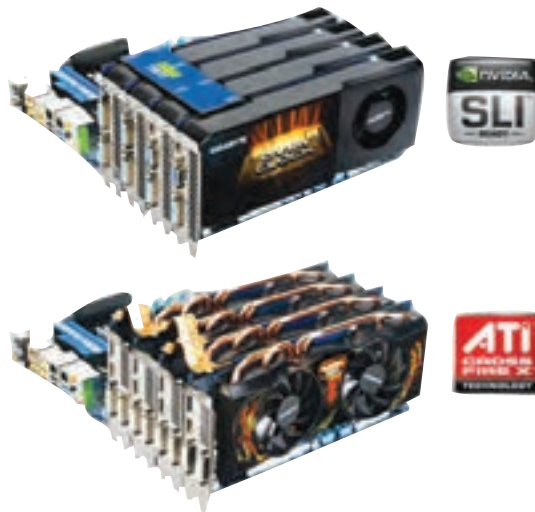
شکل ۲۵-۸ نصب کارت‌های گرافیک CrossFire و SLI
