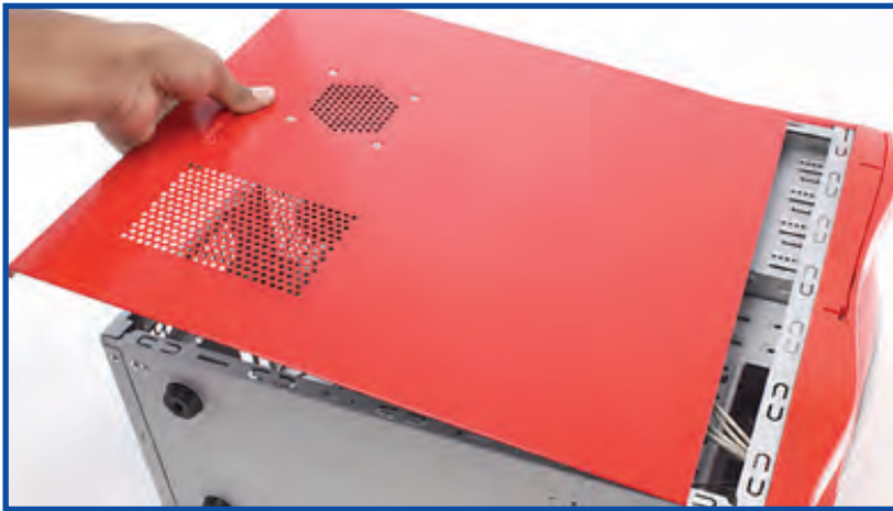
شکل ۸-۱ برداشتن قاب‌های جانبی
