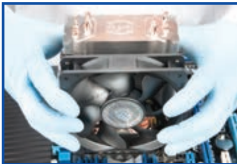
شکل ۸-۹ نصب خنک کننده پردازنده
