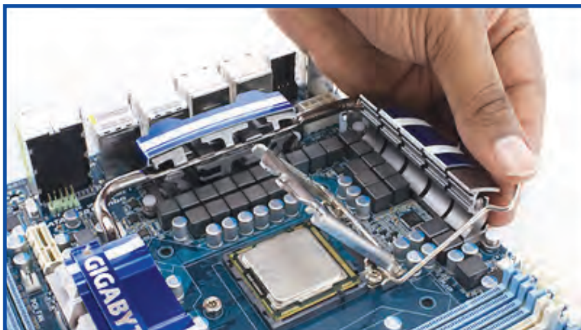
شکل ۶-۸ بستن پوشش فلزی سوکت پردازنده
