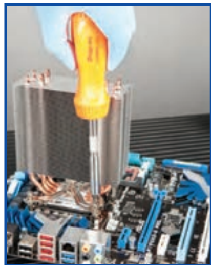
شکل ۸-۸ نمونه‌ای از نصب پایه خنک کننده
