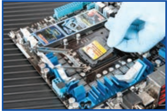
شکل ۴-۸ برداشتن پوشش محافظ سوکت پردازنده
