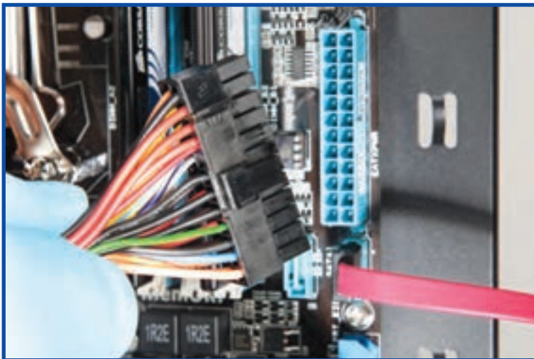
شکل ۸-۱۷ اتصال کابل‌های برق برد اصلی به منبع تغذیه
