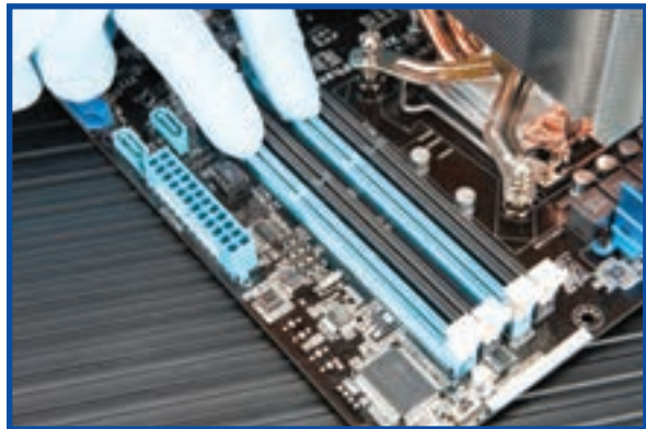
شکل ۱۰-۸ هماهنگ کردن فرورفتگی ماژول حافظه با برآمدگی شکاف حافظه
