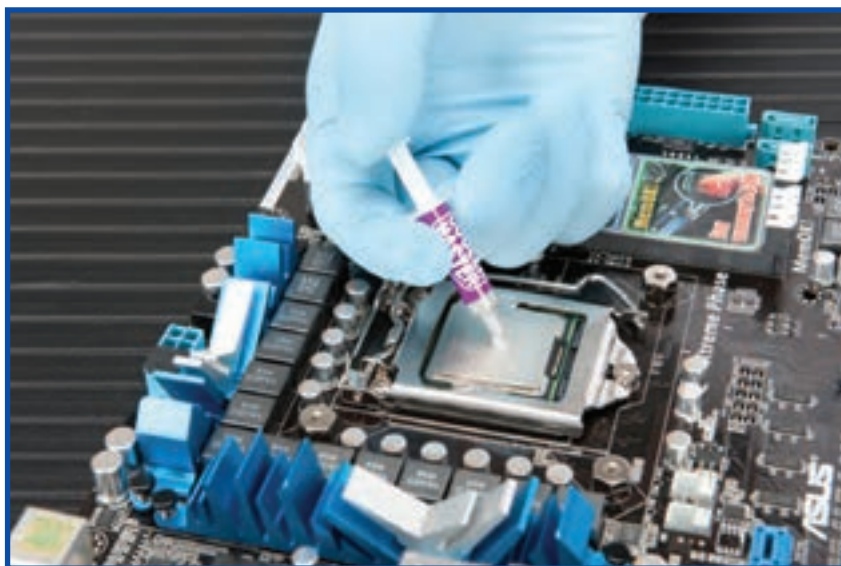
شکل ۷-۸ پوشاندن پردازنده با خمیر انتقال حرارت
