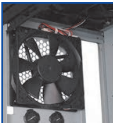
شکل ۳-۸ نصب پروانه خنک‌کننده کیس
