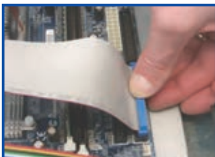
شکل ۸-۲۲ نصب کابل IDE
