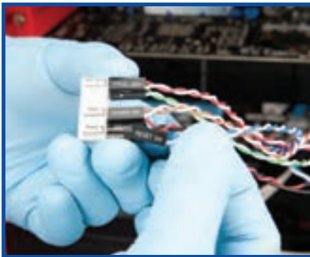
شکل ۱۹-۸ نصب و اتصال کانکتورهای پانل جلوی کیس
