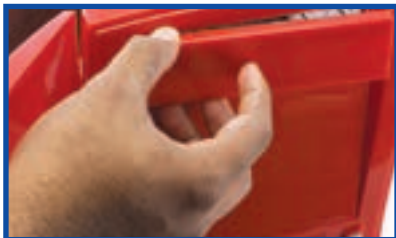
شکل ۲۰-۸ برداشتن پانل جلوی کیس
