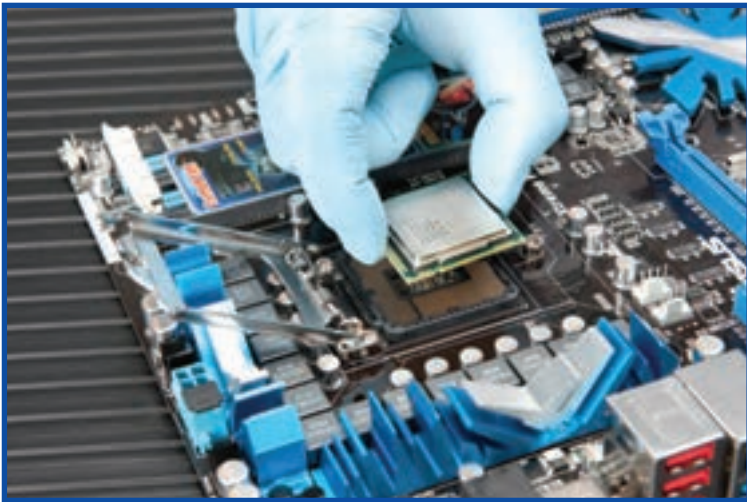
شکل ۵-۸ هماهنگ کردن فرورفتگی‌های پردازنده با برآمدگی‌های روی سوکت
