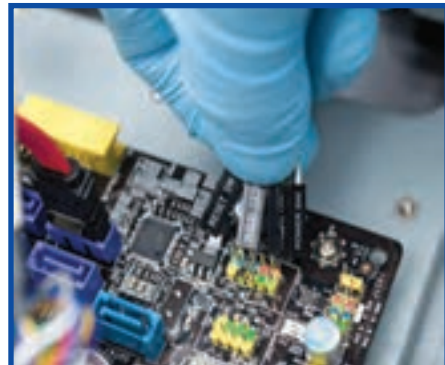
شکل ۱۹-۸ نصب و اتصال کانکتورهای پانل جلوی کیس
