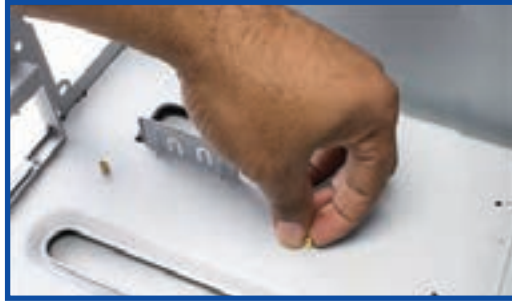
شکل ۸-۱۲ ثابت کردن پایه‌های برنجی
