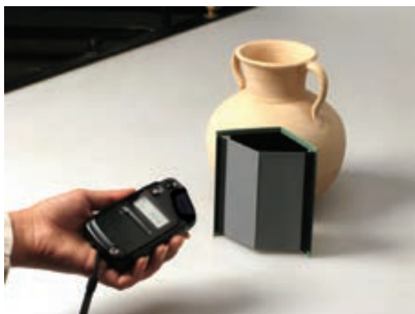
تصویر ۹-۷- نورسنجی بازتابی از کارت خاکستری
