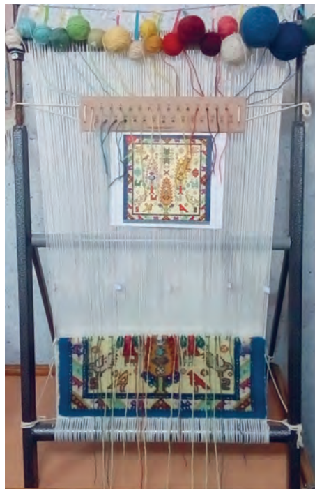
شکل ۹-۱- زیردار ثابت و سردار متحرک (مدل ۱)
