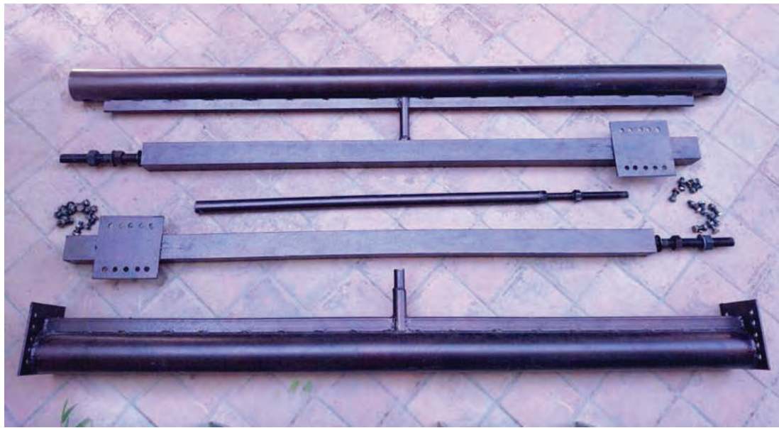
شکل ۱۵-۱- متعلقات یک دار قالی بافی (دو راست رو، زیر دار، سردار، جک، پیچ و مهره)
