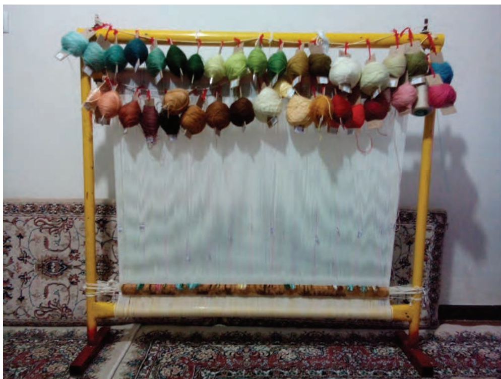
شکل ۶-۱- دار قالی بافی عمودی
