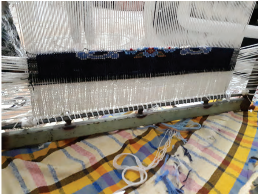
شکل ۲۶-۱- میله جوش شده، روی زیر دار از داخل، جهت دوخت ابتدای چله بعد از چله ریزی با نخ پنبه ای ضخیم
