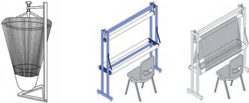
شکل ۱۳-۱ مدلی از دار قالی ارگونومیک
