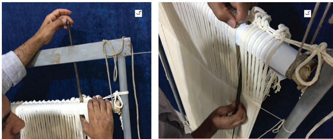
شکل ۱۳-۳- گره زدن دسته‌های چله بر روی سردار و تنظیم آنها
