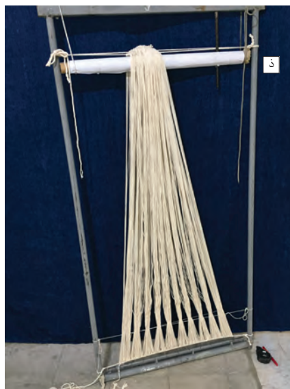
شکل ۸-۳- مه‌ار ابتدای چله به زیردار
