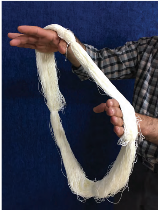
شکل ۲۳-۲- وارد کردن دست‌ها به داخل کلاف و باز کردن تاب‌های فرعی
