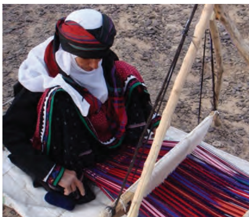
شکل ۱۹-۳- چله‌ریزی بر روی دستگاه برای بافت جاجیم
