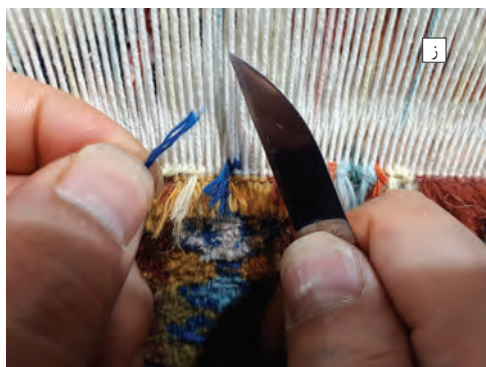
شکل ۱۲-۴- نحوه اجرای گره فارسی
