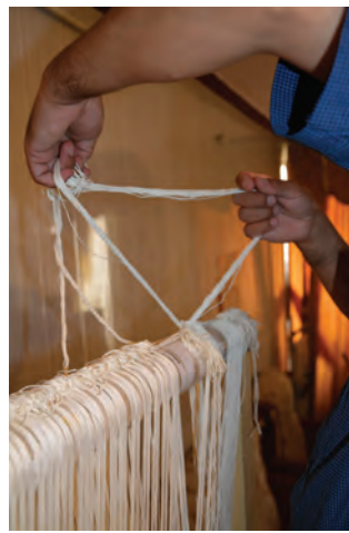
شکل ۱۱-۵ - باز کردن گره‌های سردار
