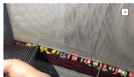
شکل ۱۸-۴- نحوه نشاندن پود رو
