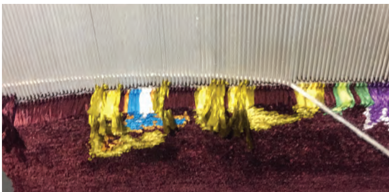
شکل ۱۷-۴- محل پود زیر در قالی از روبرو
