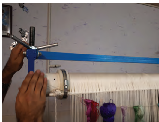
شکل ۳۵- ۵- شل کردن دار
