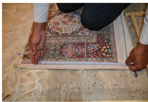
شکل ۲۰-۵ - اندازه گیری میزان پایین کشی
