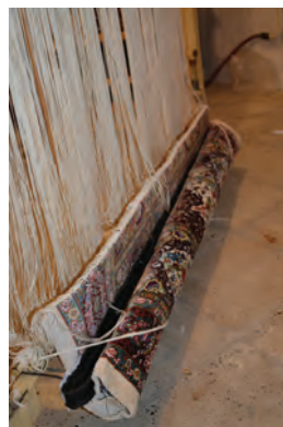
شکل ۳۰-۵ - قالی پایین کشی شده قبل از سفت کردن مجدد دسته‌های چله
