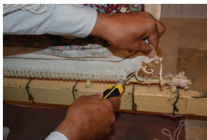
شکل ۱۳-۵ - بریدن دوخت ابتدای چله
