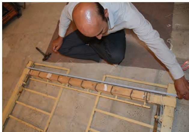
شکل ۱۶-۵ - نصب چوب پایین کشی پشت زیردار
