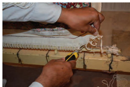
شکل ۱۳-۵ - بریدن دوخت ابتدای چله
