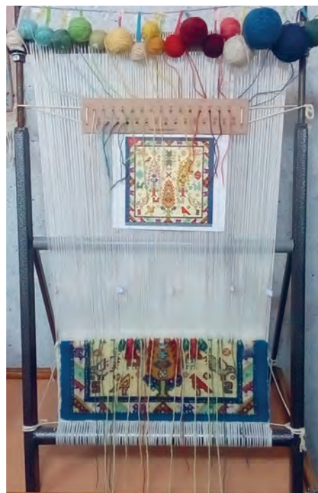
شکل ۹-۱- زیر دار ثابت و سردار متحرک (مدل ۱)
