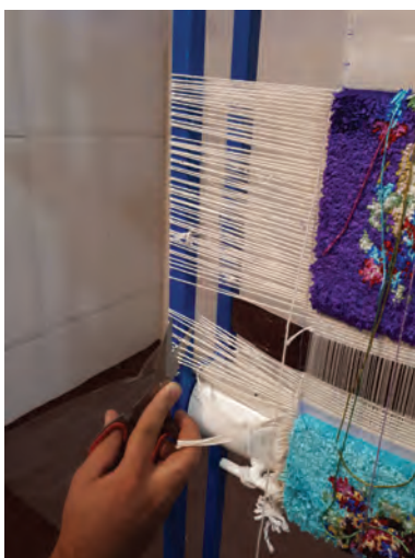
شکل ۳۴-۵ - بریدن انتهای پودها قبل از پایین کشی
