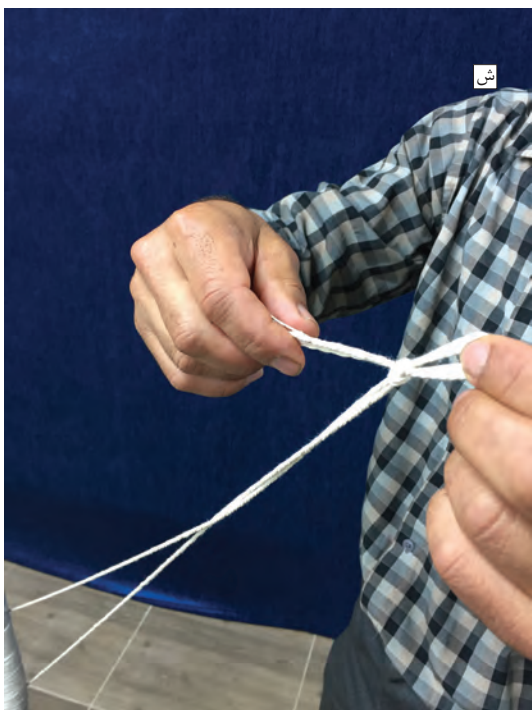
شکل ۳۷-۲- بستن نخ‌های کمکی
