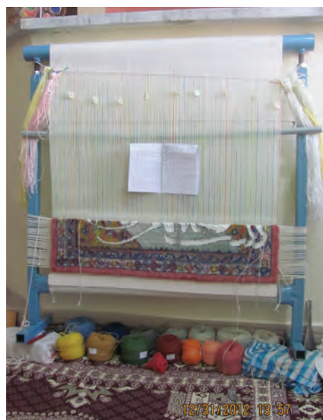
شکل ۱۰-۱- زیر دار ثابت و سردار متحرک (مدل ۲)
