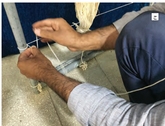
شکل ۷-۳- بازکردن نخ‌های کمکی
