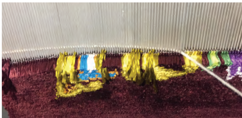
شکل ۱۷-۴- محل پود زیر در قالی از روبرو
