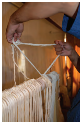
شکل ۱۱-۵- باز کردن گره‌های سر دار
