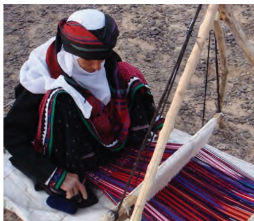
شکل ۱۹-۳- چله‌ریزی بر روی دستگاه برای بافت جاجیم
