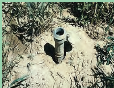
شکل ۱۲- شیر خودکار، رایزر و آبیاش
