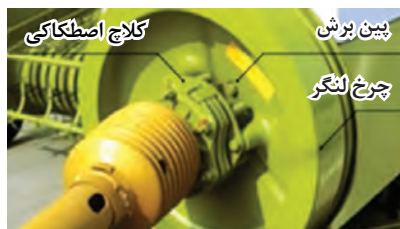
شکل ۱۱- پین برشی و کلاچ ایمنی در دستگاه بسته‌بند
