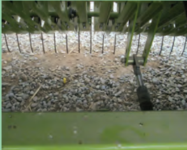
شکل ۲۲- جک هیدرولیکی جهت تنظیم ارتفاع واحد بردارنده
