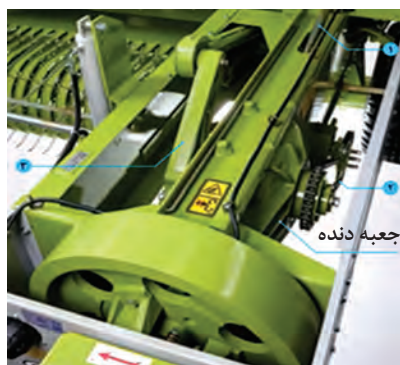
شکل ۱۲- مسیر انتقال توان در دستگاه بسته‌بند
