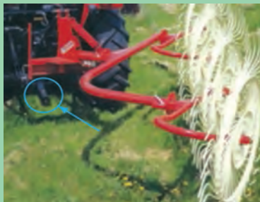
شکل ۹- اتصال شانه خورشیدی به تراکتور
