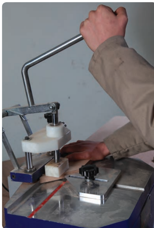
شکل ۱۱۲-۲ برش با زاویه ۴۵ درجه
