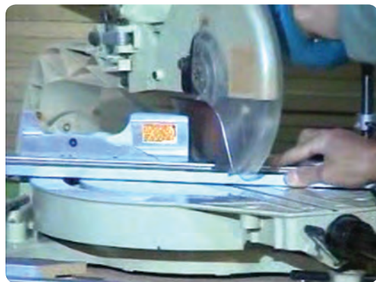
شکل ۹۲-۶ برش پروفیل‌ها با دستگاه فارسی بر
