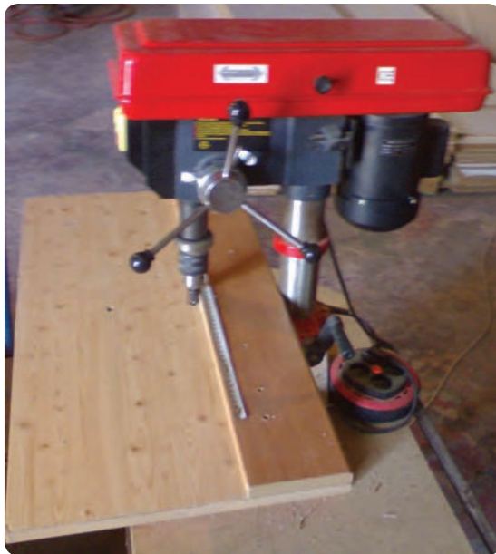
شکل ۶-۷۰- دریل ستونی همراه با شابلن جهت سوراخ‌کاری
