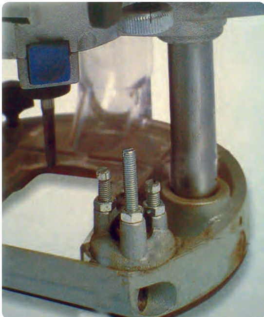
شکل ۲-۴۴ پیچ‌های تنظیم ارتفاع اور فرز دستی برقی
