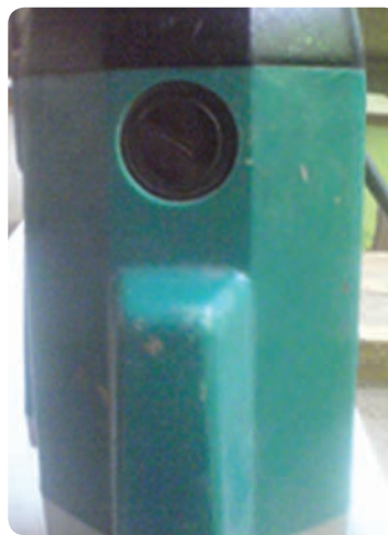
شکل ۶۷-۲ محفظه قرارگیری زغال کلکتور
