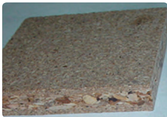
شکل ۳۳-۱ تخته خرده چوب سه لایه
