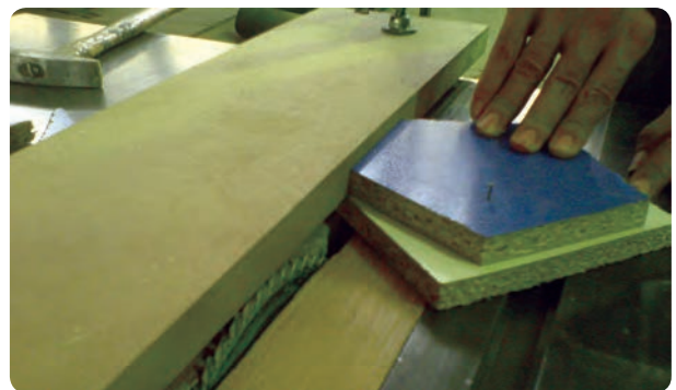
شکل ۳-۴۰ مماس کردن به گونیا و انجام دادن برش
