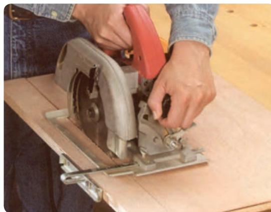
شکل ۲-۲۲ برش عرضی با گونیای ماشین
