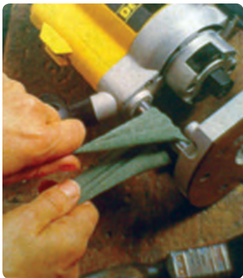
شکل ۶۶-۲ تمیز کردن میله‌های کنسویی اورفرز
