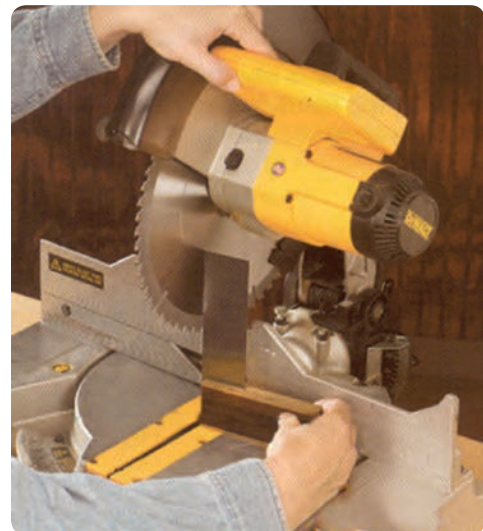
شکل ۷-۲ تنظیم عمود بودن تیغه پشت به صفحه
