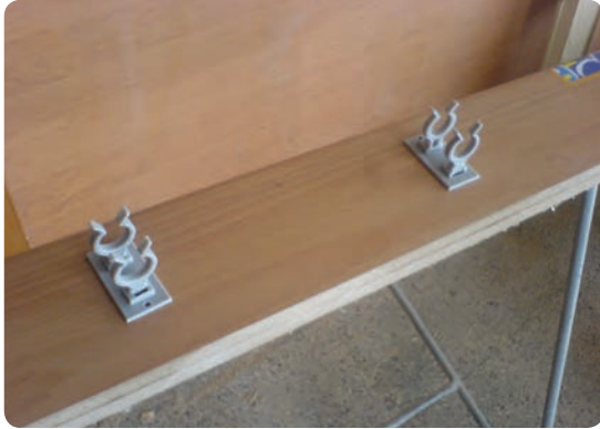
شکل ۶-۶۵ اتصال کلیپس پاسنگ به پایه کابینت
