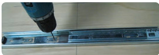
شکل ۷-۳۳ سوراخ‌کاری محل استقرار ریل روی بدنه فایل
