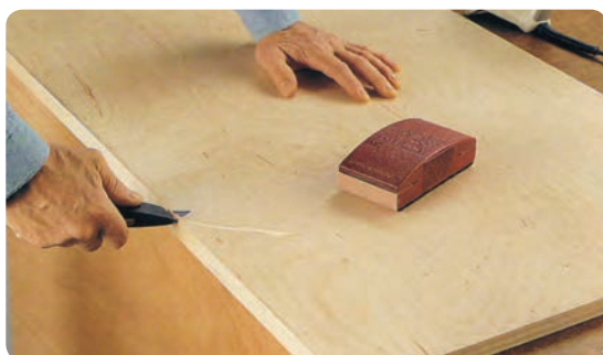
شکل ۸-۷۷ پرداخت لبه‌های اضافی روکش لبه‌چسبان
