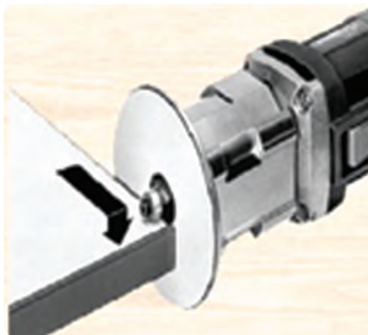
شکل ۱۵۵-۲ پرداخت لبه‌های اضافی روکش مصنوعی
