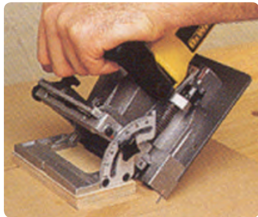
شکل ۲-۹۰ شیارزنی با زاویه ۴۵ درجه
