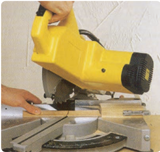
شکل ۲-۱۲- برش قائم با اره گرد فارسی بر
