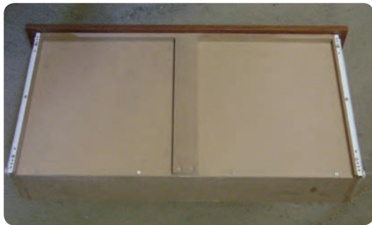
شکل ۶-۱۱۳ نصب قید کمرکش در کنسولهای بزرگ
