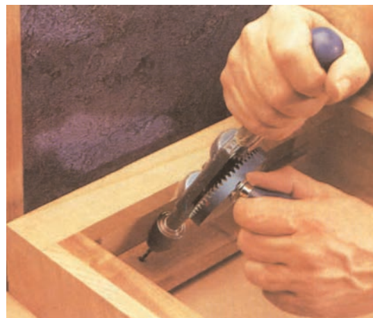
شکل ۶-۱۶۱ مونتاژ صفحه میز به قاب دراور
