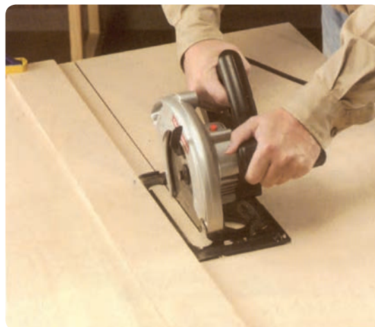
شکل ۲-۲۳ برش طولی با گونیای برراستی
