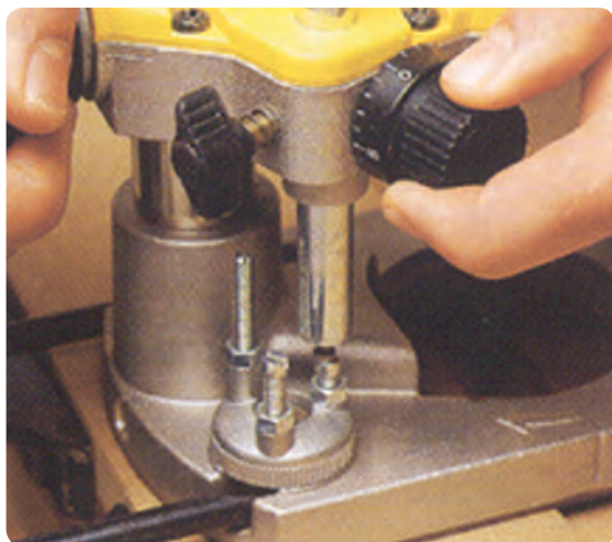
شکل ۷۲-۲ پیچ‌های تنظیم دستگاه
