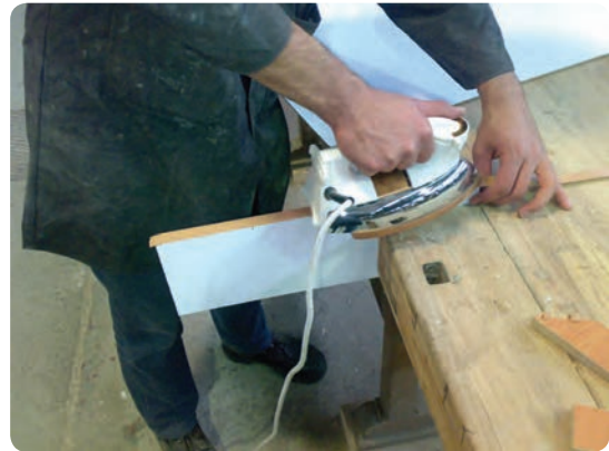
شکل ۱۴۷-۲ اتوکشی نوار روکش لبه چسبان
