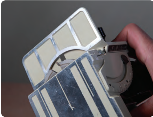
شکل ۲-۹۴ اتصال زن بیسکویتی بدون گونیا
