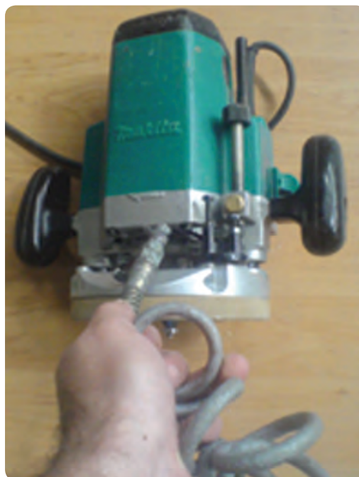
شکل ۷۱-۲ بادگیری دستگاه پس از پایان کار
