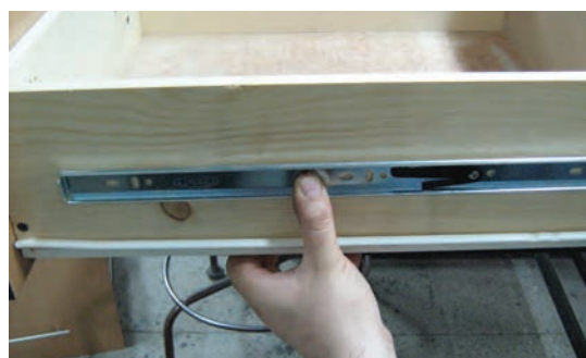
شکل ۷-۳۵ تعیین محل ریل بر روی بدنه کشو
