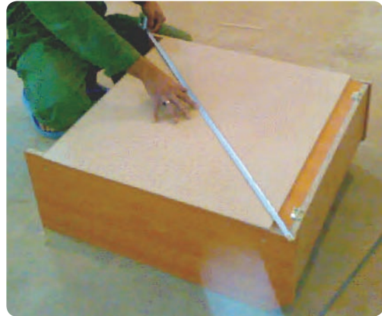
شکل ۱۳۰-۶ کنترل دویدگی کابینت
