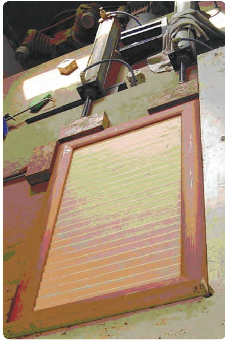
شکل ۶-۹۷ تنگ نیوماتیکی جهت مونتاژ در قابدار کابینت
