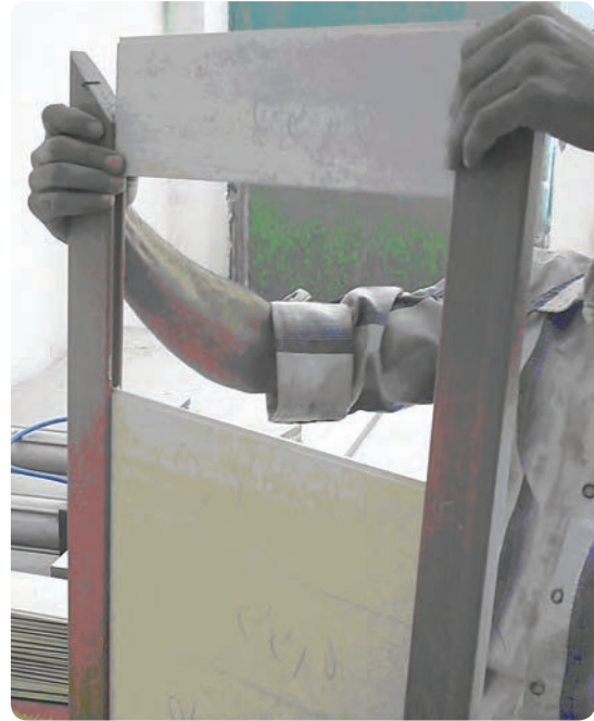
شکل ۶-۹۵ مونتاژ در قابدار با تنگ لته‌ای
