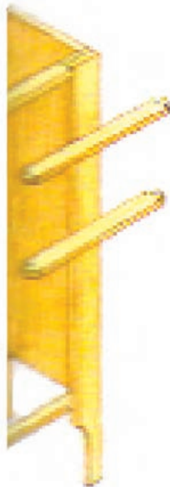
شکل ۶۳-۸ موقعیت قیدهای عرضی داخلی در کابینت پایه‌دار
