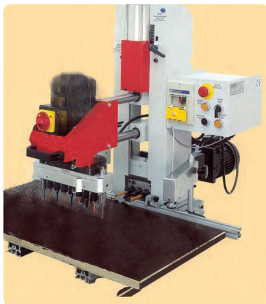
شکل ۲-۱۲۶ سوراخ زن رومیزی با قابلیت سوراخ کاری در جهت عمودی و افقی با دو الکتروموتور
