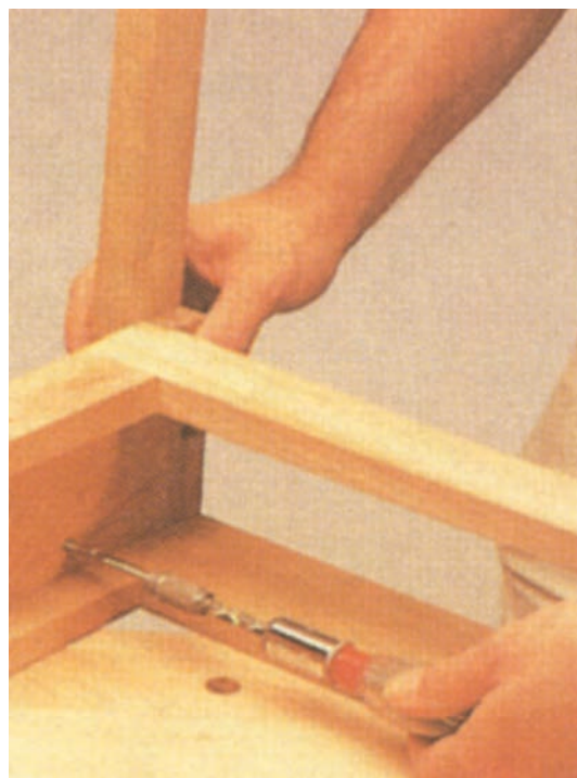
شکل ۱۵۹-۶ اتصال قاب دراور به قاب کناری
