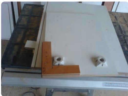
شکل ۶-۱۱۴ شابلون گونیايي جهت نصب پایه کابینت
