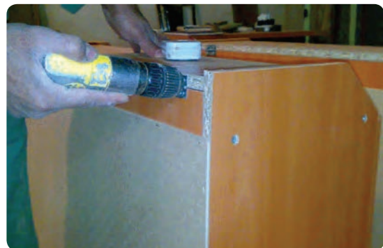
شکل ۱۳۱-۶ نصب لولای محفظه جاواکسی
