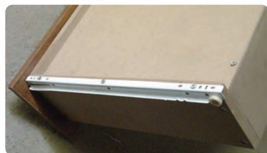
شکل ۶-۱۱۲ نصب ریل مکانیکی در زیر بدنه جعبه
