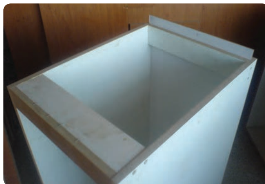
شکل ۶-۷۵ مونتاژ کابینت با قرارگیری پشت‌بند
