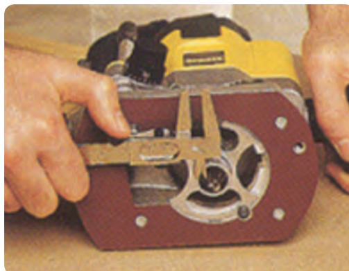
شکل ۶۸-۲ اندازه‌گیری قطر شفت فرز
