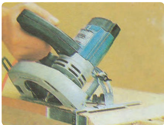
شکل ۳۷-۲ برش تحت زاویه به وسیله گونیای دستگاه
