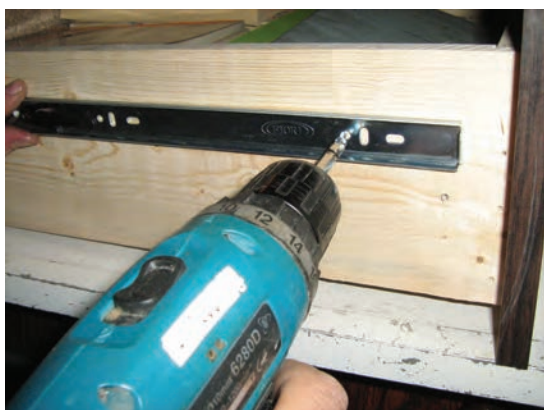
شکل ۷-۳۶ نصب ریل بر روی بدنه‌ی کشو
