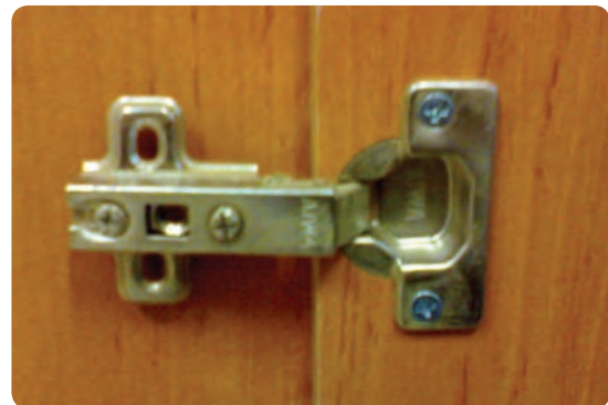
شکل ۶-۸۵ نصب کاسه لولا روی در کابینت
