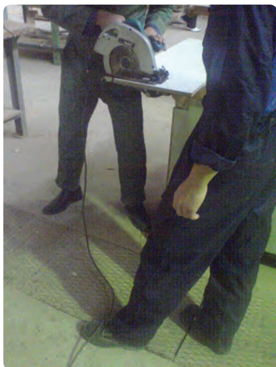
شکل ۲۷-۲ سیم سیار در مسیر نباشد
