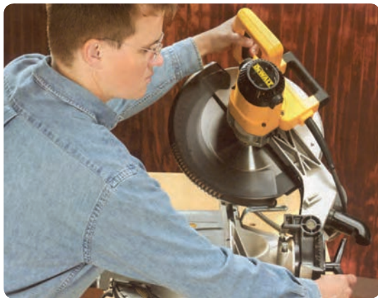
شکل ۹-۲ تنظیم زاویه چرخش اهر گرد
