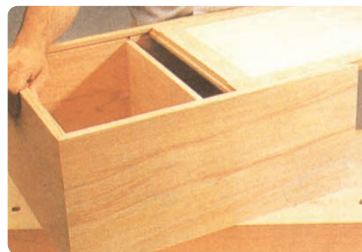
شکل ۱۴۳-۶ قرارگیری پشت بند در کنشکاف بدنه کابینت
