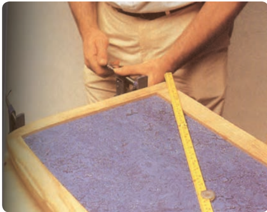
شکل ۶-۱۵۳ تنگ بستن صفحه میز
