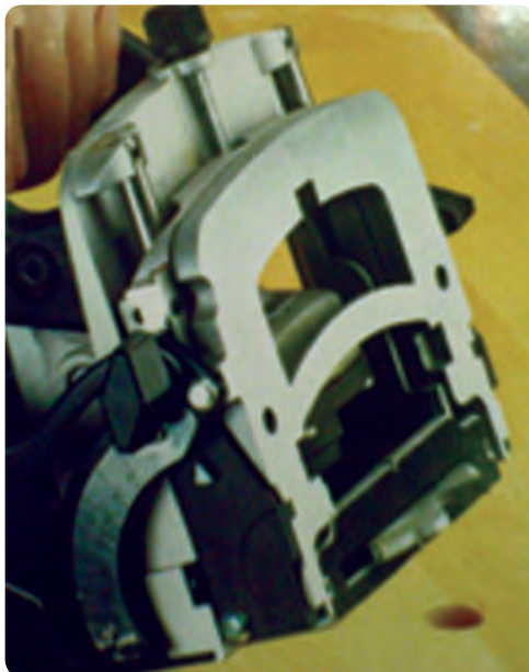
شکل ۲-۹۲ نشان دهنده موقعیت تیغه روی دستگاه
