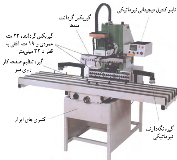
ماشین سوراخ‌زنی و لولازنی دیجیتال نیوماتیک
