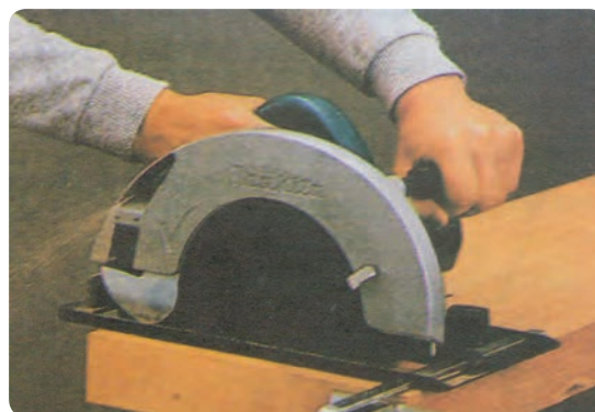
شکل ۳۶-۲ برش به وسیله گونیای دستگاه
