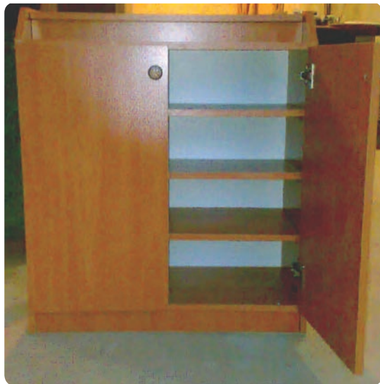
شکل ۱۳۲-۶ نصب پراق آلات در کابینت جاکفشی
