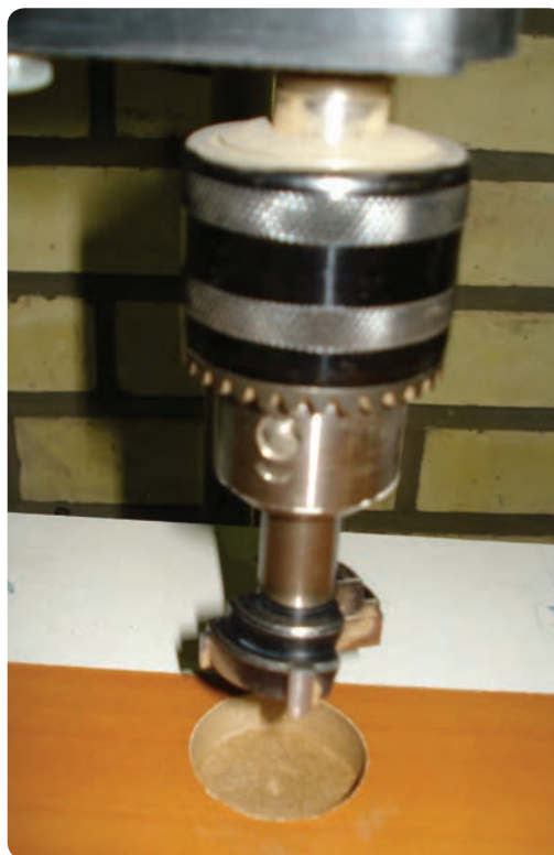
شکل ۶-۷۱ مته کابینت جهت سوراخ کردن جای لولا
