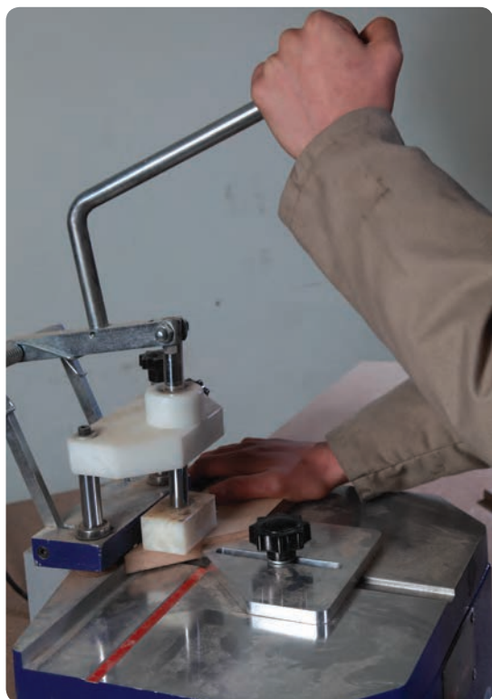
شکل ۹۳-۶ اتصال دم چلچله زن پروفیل
