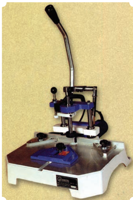
شکل ۲-۱۰۵ ماشین دم چلچله زن پایه کوتاه
