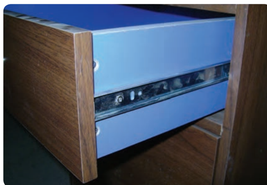
شکل ۵۶-۶ ریل مکانیکی نصب شده در بدنه جعبه
