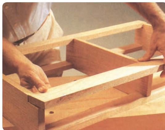
شکل ۶-۱۵۵ مونتاژ کلاف قاب دراور
