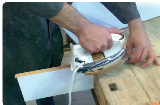
شکل ۶-۸۱ لبه چسبانی روکش مصنوعی با اتو
