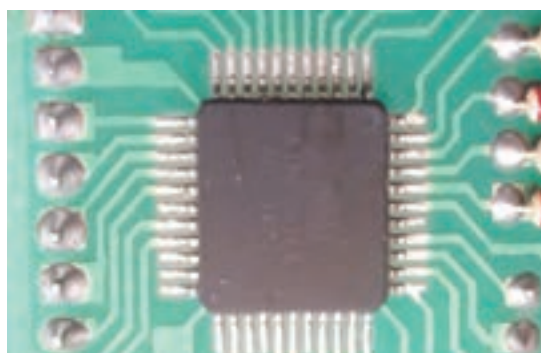
شکل ۳-۱۰ قرار دادن قطعه در محل خود
