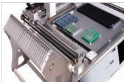
شکل ۳-۱۶ نمونه‌هایی از دستگاه Pick And Place
