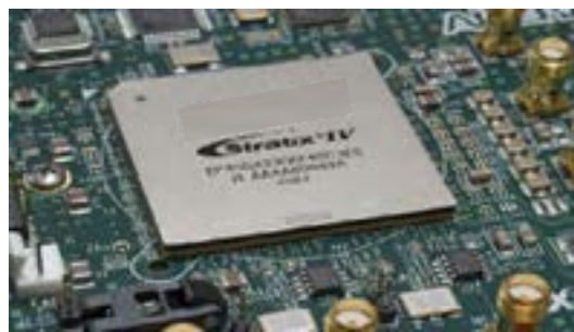
شکل ۲۳-۵ کاربرد آی‌سی FPGA در مدارهای پیشرفته
