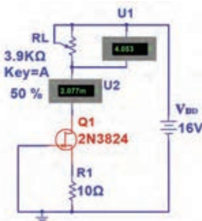
شکل ۳۳-۴- مدار منبع جریان با FET
