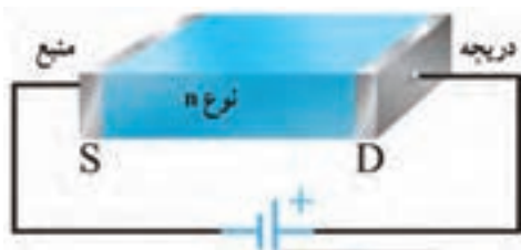
شکل ۴-۱۷- نیمه‌هادی با ناخالصی N به عنوان کانال
