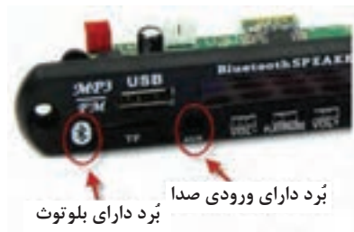
شکل ۵-۷- بُرد دارای بلوتوث و ورودی صدا
