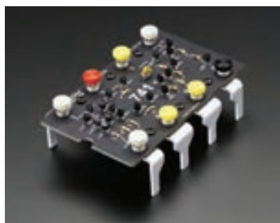
شکل ۴-۵۴- مدار داخلی آی سی ۷۴۱ با قطعات مجزا
