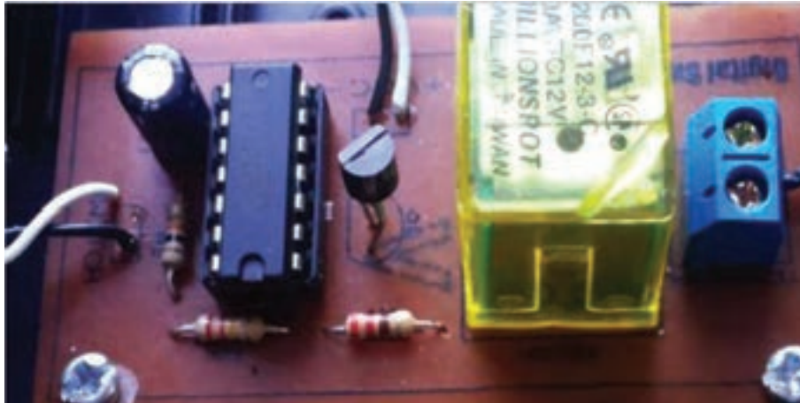
شکل ۹۶-۴ مدار مونتاژ شده کلید الکترونیکی
