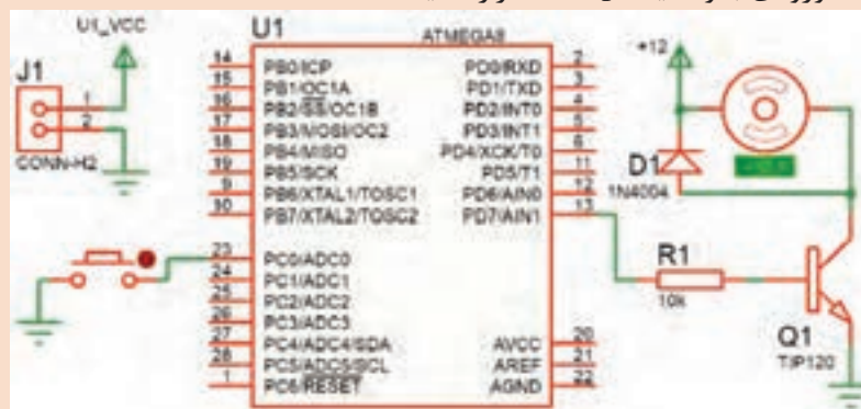
شکل ۳۳-۷ مدار کنترل موتور توسط میکروکنترلر
