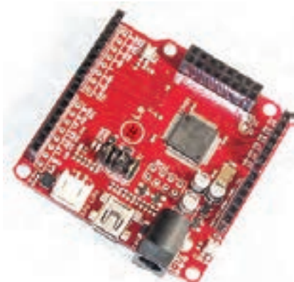
ب) برد مدار چاپی پروژه میکروکنترلر
