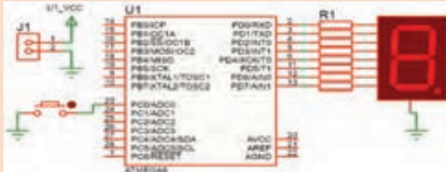
شکل ۷-۳۸ مدار شمارنده یک رقمی
