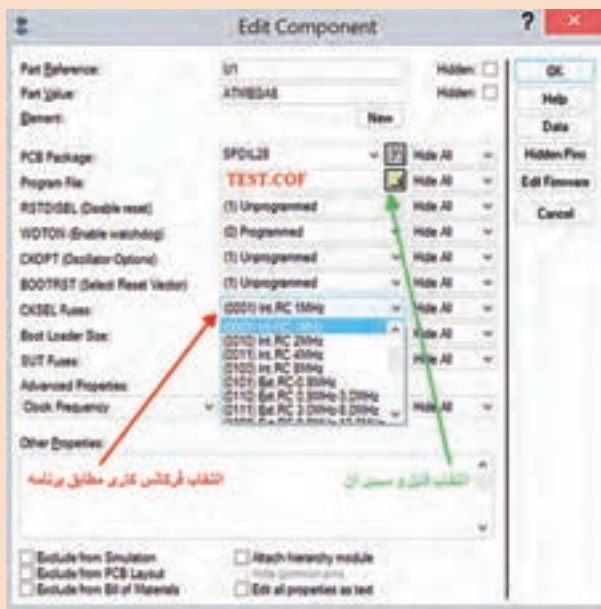
شکل ۷-۱۶ پنجره ویرایش و تنظیم میکروکنترلر برای اجرا در پروتئوس
