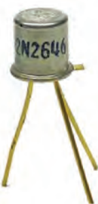
شکل ۷-۵۲ یک نمونه UJT
