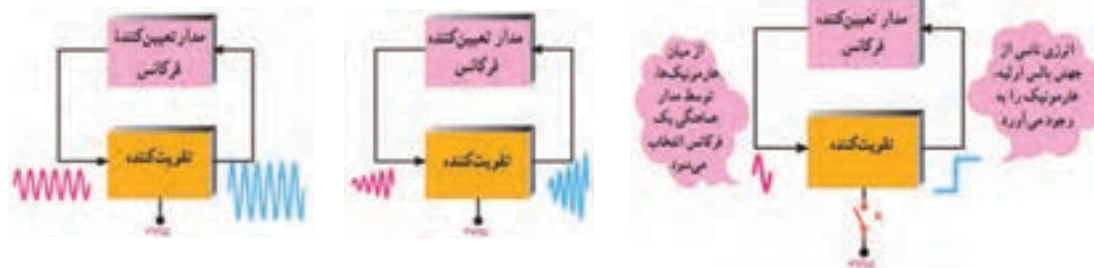
شکل ۶-۳۱ مراحل تولید نوسان
