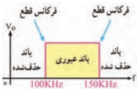
شکل ۵-۶ منحنی پاسخ فرکانسی فیلتر ایده‌آل
