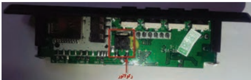
شکل ۵-۸- برد MP۳ با رگولاتور ۷۸۰۵ داخلی
