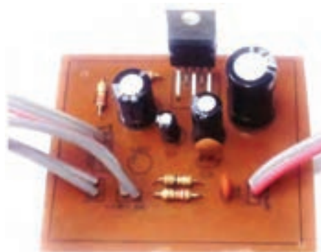
شکل ۴-۹۰- مدار مونتاژ شده تقویت کننده
