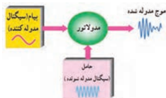
شکل ۶-۴۸ بلوک دیاگرام نحوه انجام مدولاسیون
