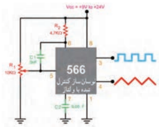
شکل ۵۷-۶ نوسان ساز با فرکانس قابل کنترل با ولتاژ
