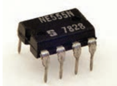
شکل ۲-۲۰- آی سی تایمر NE۵۵۵
