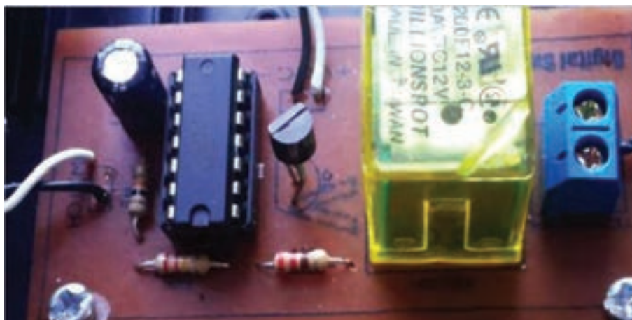
شکل ۹۶-۴ مدار مونتاژ شده کلید الکترونیکی
