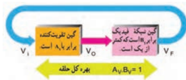
شکل ۶-۳۰ بررسی اصل بارک‌هاوزن
