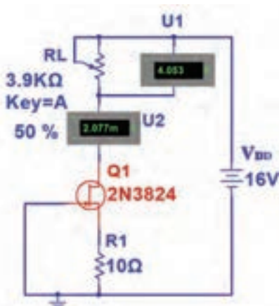
شکل ۳۳-۴- مدار منبع جریان با FET
