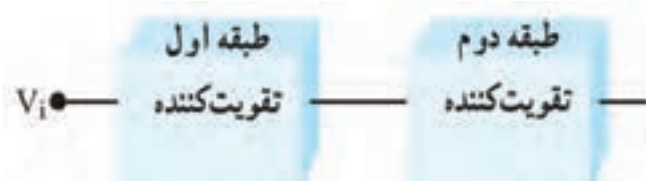
شکل ۹-۴- بلوک دیاگرام دو طبقه تقویت کننده با کوپلاژ مستقیم
