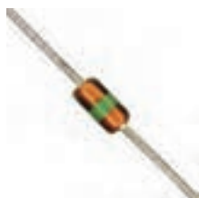
شکل ۷-۳۹ شکل ظاهری دیاک
