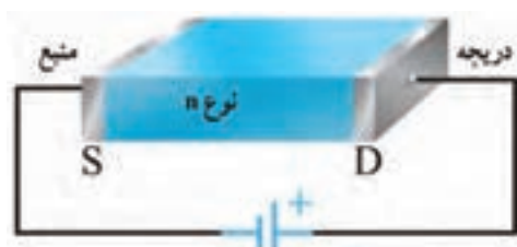
شکل ۴-۱۷- نیمه‌هادی با ناخالصی N به عنوان کانال
