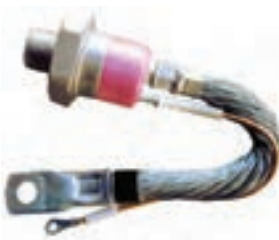
شکل ۷-۴۳ چند نمونه ترایاک
