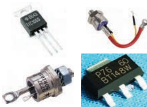
شکل ۸-۷ بسته‌بندی چند نمونه SCR
