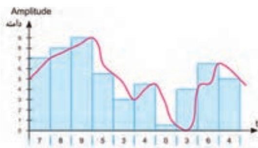
شکل ۶-۷۰ نمونه‌برداری از سیگنال آنالوگ
