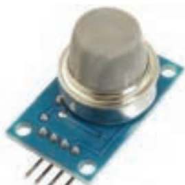
شکل ۴-۹۸- ماژول تشخیص گاز خانگی
