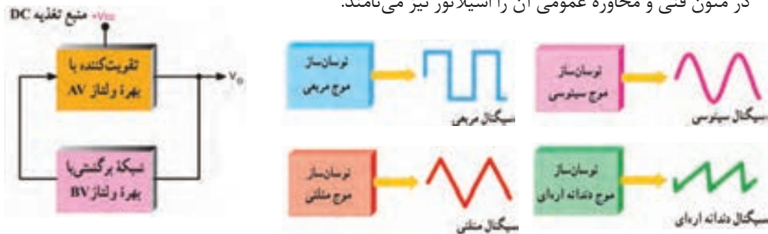
شکل ۶-۲۵ بلوک دیاگرام کلی نوسان‌ساز
