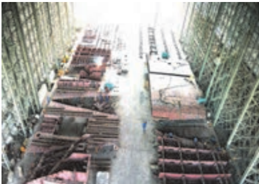
شکل ۵- جوش کاری بلوک کشتی
