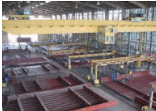
شکل ۴- اسمبل کردن بلوک کشتی
