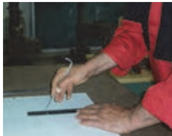
شکل ۱۴- استفاده از خطکش و سوزن خطکش
