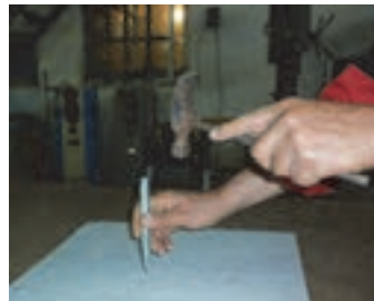
شکل ۱۳- استفاده از سنبه برای نشانه‌گذاری
