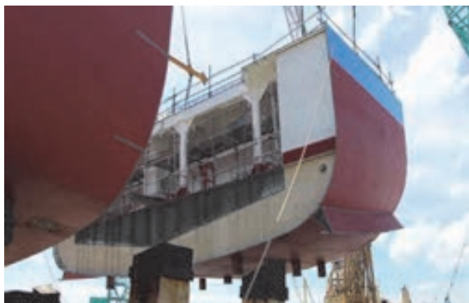
شکل ۸- اتصال بلوک‌های کشتی
