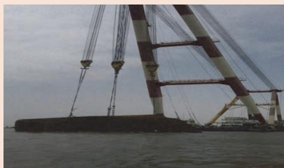
عملیات خارج‌سازی شناور "کارون‌بار" با استفاده از جرثقیل شناور از قعر آب‌های اروندرود
