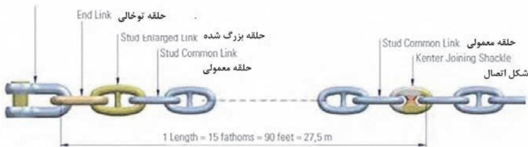
شکل ۳-۵- نحوه قرار گرفتن شکل‌ها و حلقه‌ها در یک طول زنجیر لنگر
