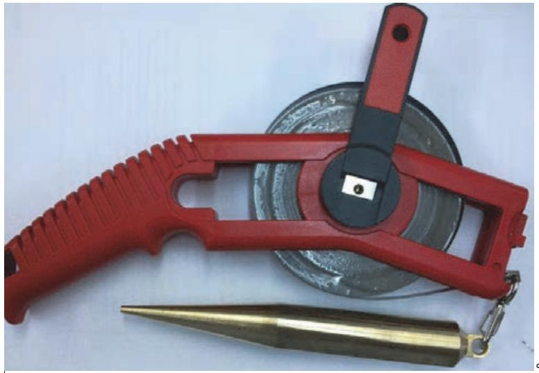
شکل-۳-۶ Sounding tape برای اندازه‌گیری سطح مخزن
