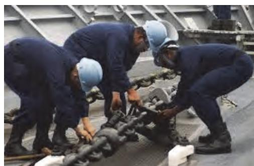
در موقع و مکان‌های مناسب مانند هنگام انتقال زنجیر به داخل کشتی و یا به هنگام تعمیرات کشتی درروی حوضچه‌های تر و خشک، حلقه‌ها شکل‌های زنجیر لنگر از نظر وجود آثار خوردگی بازدید شده و در صورت لزوم باز و تعویض گردد.
