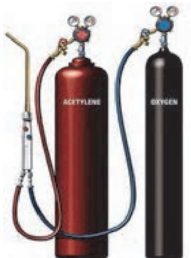
شکل ۲۹- یک واحد جوش کاری گاز
