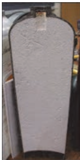
شکل ۷- کیسول برش خورده استیلن
