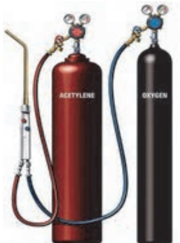
شکل ۲۹- یک واحد جوش کاری گاز
