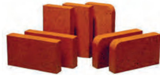
شکل ۲۶- آجرهای دیرگداز سیلیسیمی
