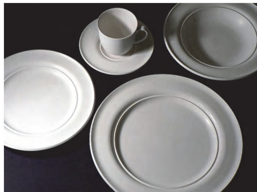
شکل ۳- قطعات تولیدشده به روش جیگر و جولی
