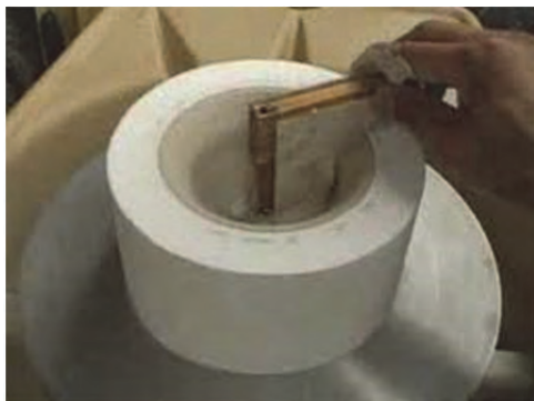
شکل ۳۵- پایین آوردن بازوی جولی و شکل‌دهی
