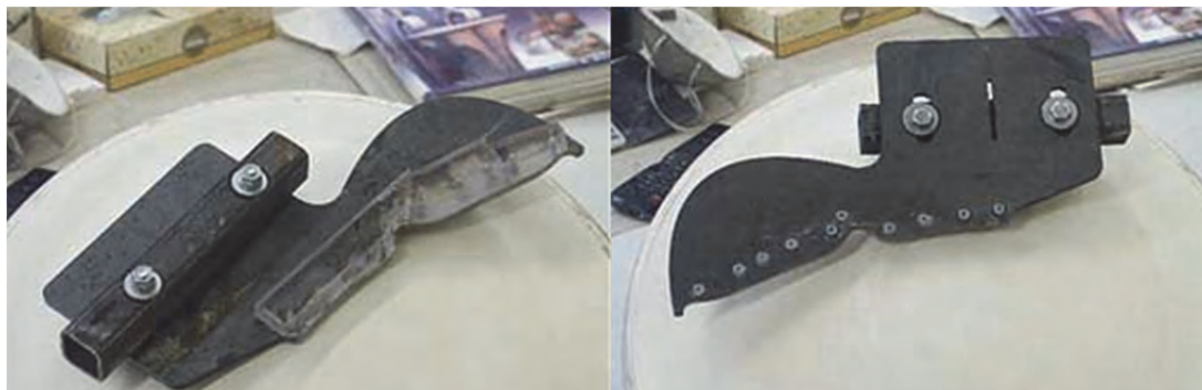
شکل ۱۶- شابلون با پیچ و مهره قابل تنظیم
