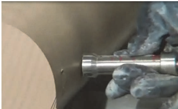
شکل ۷- اندازه‌گیری سختی شمش گل قبل از شکل‌دهی
