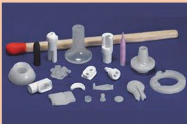
شکل ۱۲- میکروسازه‌های سرامیکی تولیدشده به روش قالب‌گیری تزریقی
