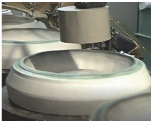
۳۴- قرار دادن دیسک گل در قالب
