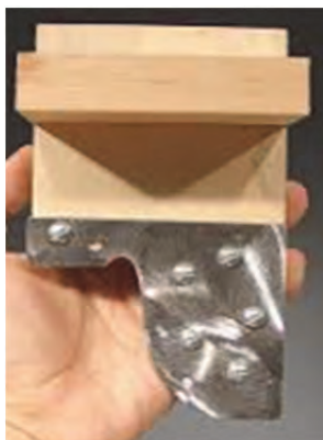
شکل ۱۴- شابلون تقویت شده با چوب
