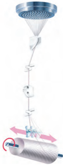
شکل ۲- قطعات سرامیکی مورد استفاده در تاباندن نخ
