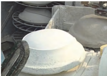
شکل ۲۷- قرار دادن قالب بر روی زبانه
