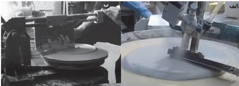
شکل ۲۸- الف) پهن کردن گل، ب) شکل دادن
