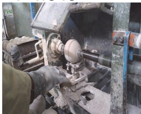
شکل ۵- شکل‌دهی قطعات سرامیکی به روش تراش
