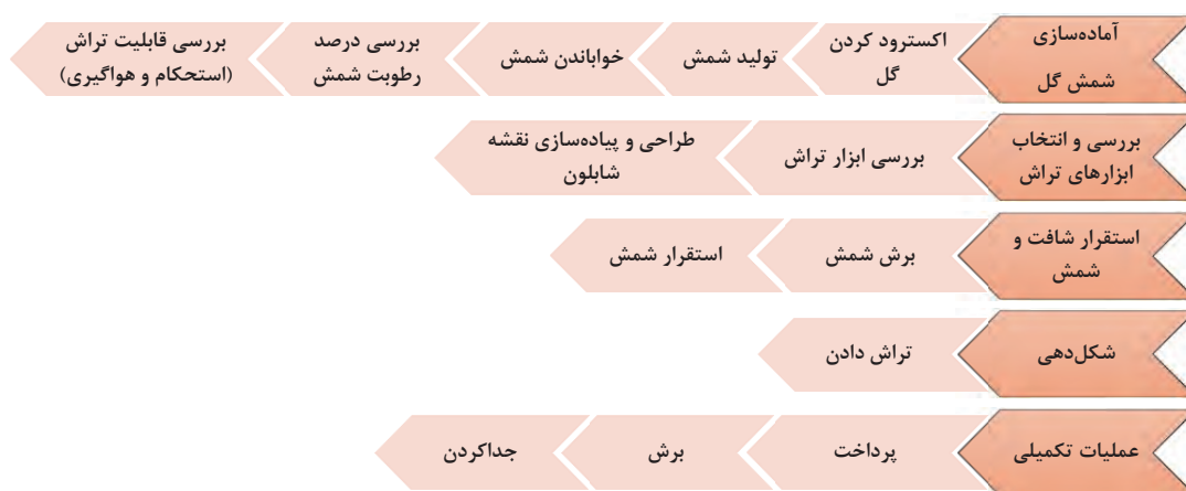
شکل ۷- مراحل شکل‌دهی گل پلاستیک به روش تراش
