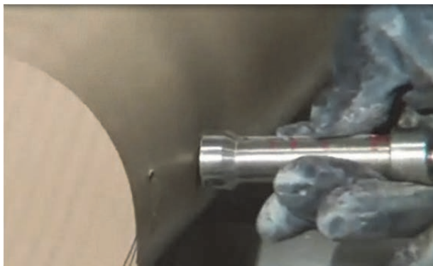
شکل ۷- اندازه‌گیری سختی شمش گل قبل از شکل‌دهی
