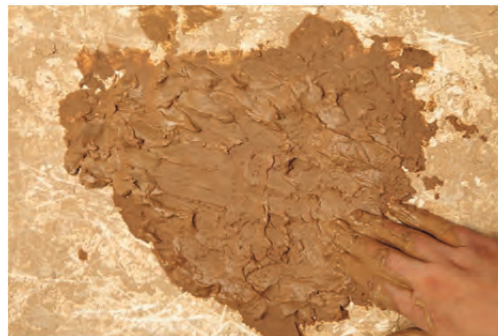
شکل ۱۰- تهیهٔ گل یکنواخت با دوغاب
