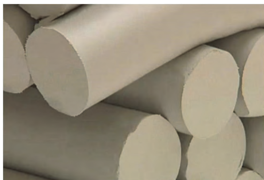
شکل ۵- اکستروود کردن گل پلاستیک
