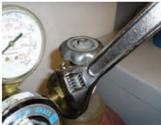
شیوه بستن شیر تنظیم به کپسول
