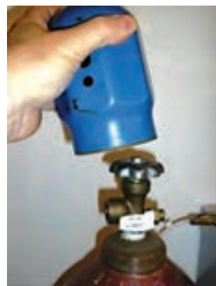
شیوه بازکردن درپوش از کپسول
