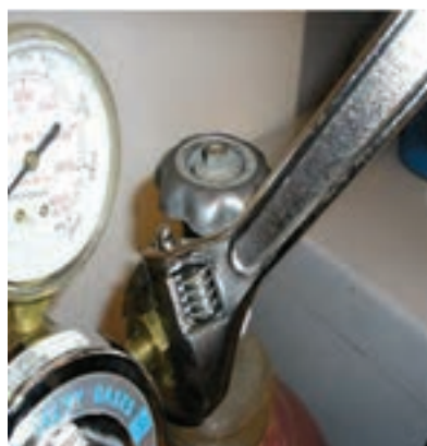
بازکردن شیر تنظیم از کپسول
