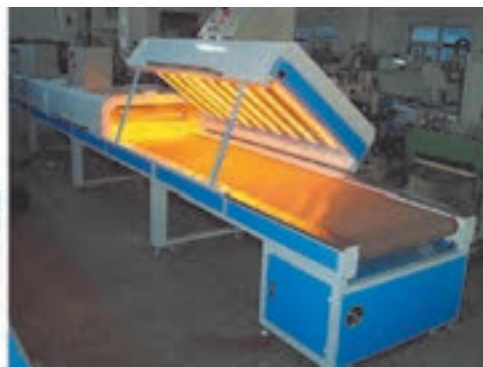
شکل ۱۵-۲- دستگاه خشک‌کن تونلی دارای نوار نقاله
