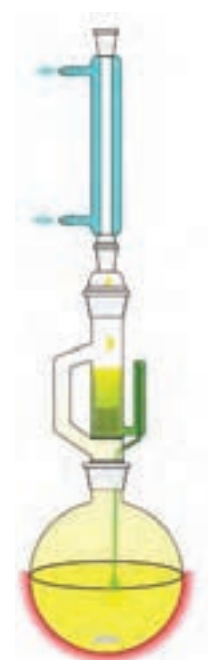
شکل ۱۷-۵- شمای ساده‌ای از سوکسله
