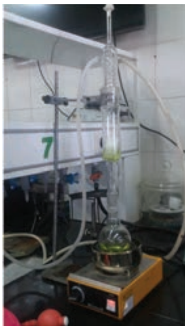
شکل ۱۷-۵- شمای ساده‌ای از سوکسله
