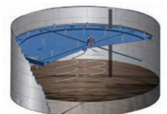
شکل ۴-۱۷- مخازن سقف شناور بیرونی
