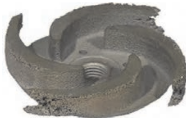
شکل ۳-۱۹- آسیب‌دیدگی پروانه پمپ در اثر پدیده کاویتاسیون
