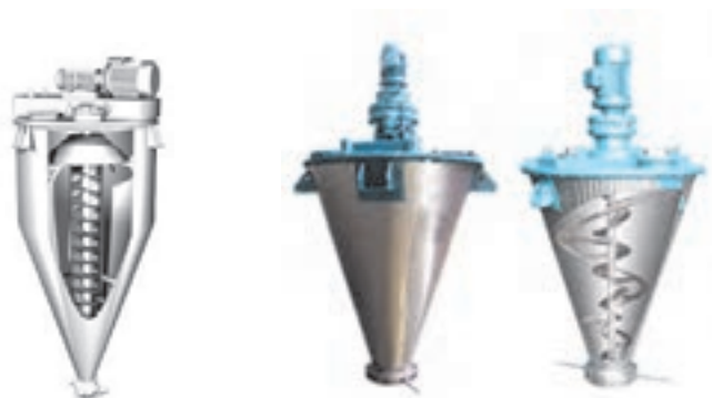
شکل ۲۴-۳- دستگاه مخلوط‌کن مارپیچ عمودی
