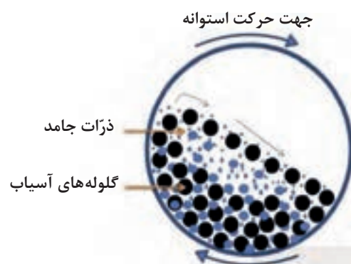
شکل ۴۳-۳. نمایی از سطح مقطع آسیاب دوار (گلوله‌ای)
