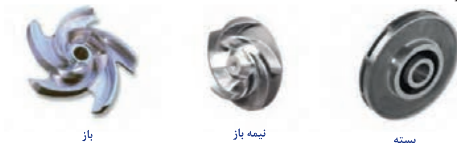
شکل ۶-۳ انواع پروانه‌ها از نظر ساختمان مکانیکی
