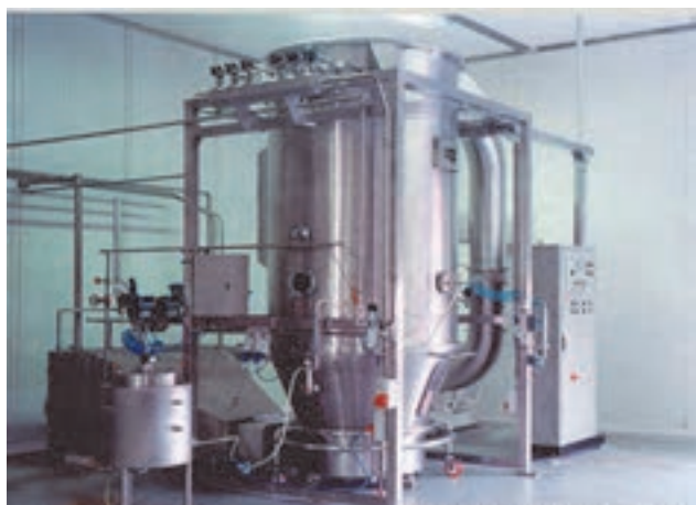
شکل ۲۵-۳- دستگاه مخلوط‌کن بستر سیال
