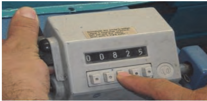
شکل ۱۹ نمونه یک دستگاه مترآژ روی دستگاه چله پیچ
