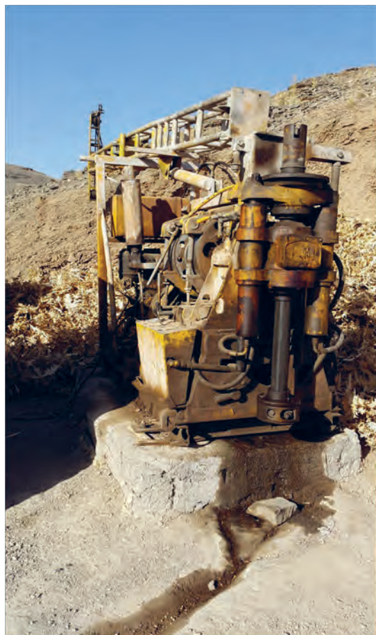
دستگاه حفاری قرار گرفته بر روی فونداسیون
