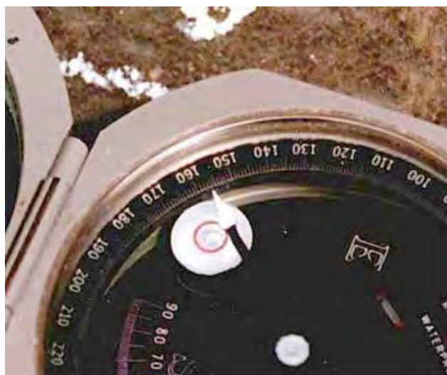
تراز کروی (چشم گاو) باید تنظیم شود
