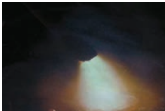
شکل ۴-۳۹: جوشکاری با طول قوس بسیار زیاد
