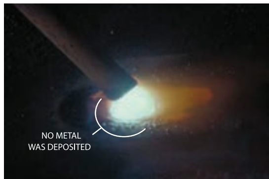
شکل ۴-۵۴: الکتروده نمی‌تواند فلز پایه را ذوب کند و در جوش رسوب نماید
