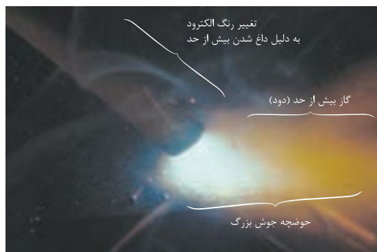
شکل ۴-۳۵: جوشکاری با آمپر بسیار بالا
