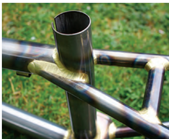
شکل ۲-۴- نمونه ای از جوش های ایجاد شده توسط فرایند زردجوش
