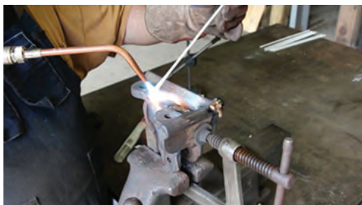
شکل ۴-۱۵- فیکسچر مورد استفاده شده در فرایند زردجوش
