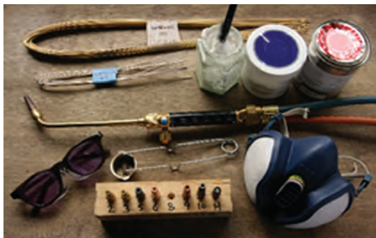
شکل ۴-۷. تجهیزات مورد استفاده فرایند زردجوش
