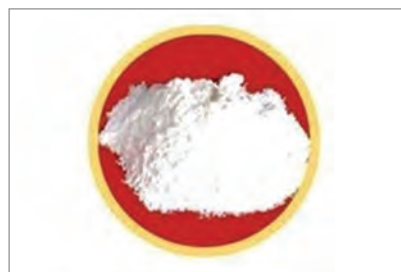
شکل ۳-۴-۱ روان ساز پودری مورد استفاده در زردجوش
