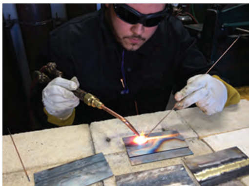
شکل ۴-۶- ذوب کردن فلز پایه و فلز پرکننده
