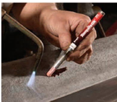
شکل ۴-۱۸- اندازه‌گیری دما توسط گچ‌های حرارتی
