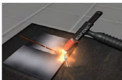
شکل ۴-۱۶- استفاده از قوس الکتریکی
