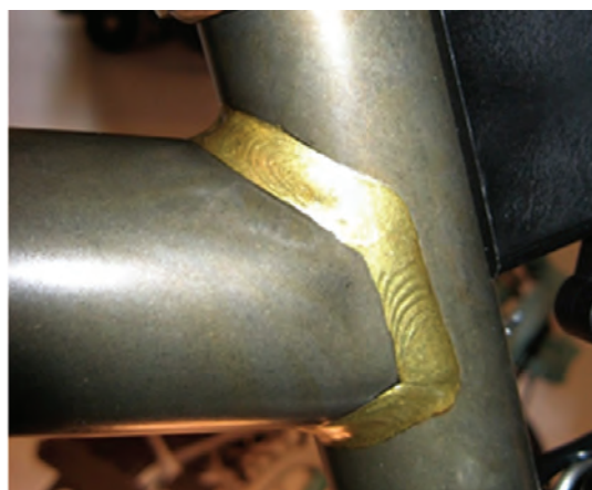
شکل ۲-۴- نمونه ای از جوش های ایجاد شده توسط فرایند زردجوش
