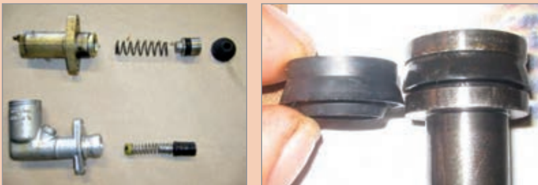
شکل ۲۱-۱- الف) نشتی داخلی در مدار هیدرولیکی
