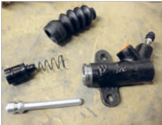
شکل ۲۴-۱ اجزای سیلندر اصلی کلاچ
