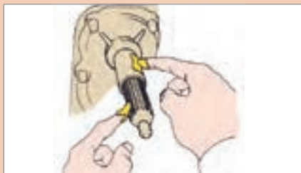
شکل ۱-۳۵- نحوه گریس کاری شفت کلاچ
