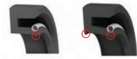
شکل ۷- نمای برش خورده کاسه‌نمد یک لبه و دو لبه
