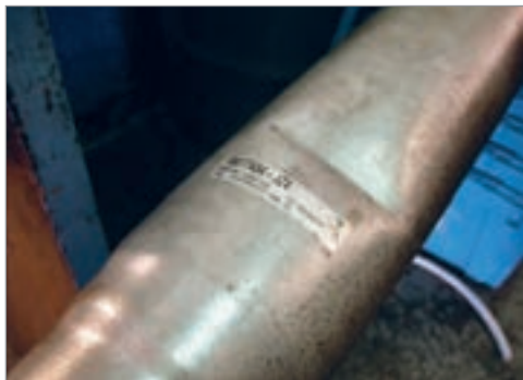
شکل ۱۵-۳- مشاهده آثار ضربه روی سطح میل گاردان
