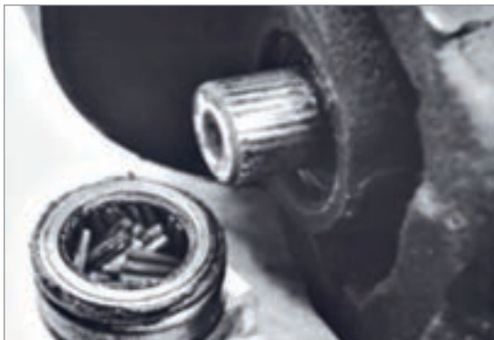
شکل ۲۳-۳- بررسی ساچمه سوزنی
